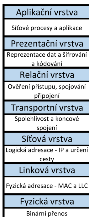
Obrázek 2.1: Jednotlivé vrstvy OSI/ISO modelu i se základním popisem funkce každé vrstvy.
