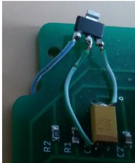
(obr. 11) Dočasné řešení s použitím lineárního regulátoru napětí
