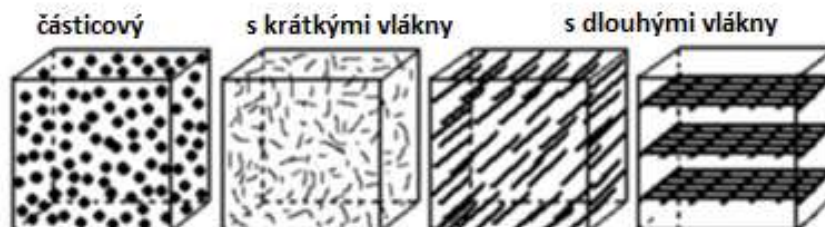
Obrázek 3 - Rozdělení kompozitních materiálů podle výztuže [03]
