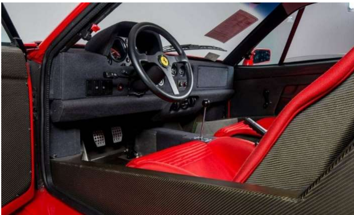
Obrázek 16 - Uhlíkový kompozit v interiéru Ferrari F40 [28]
