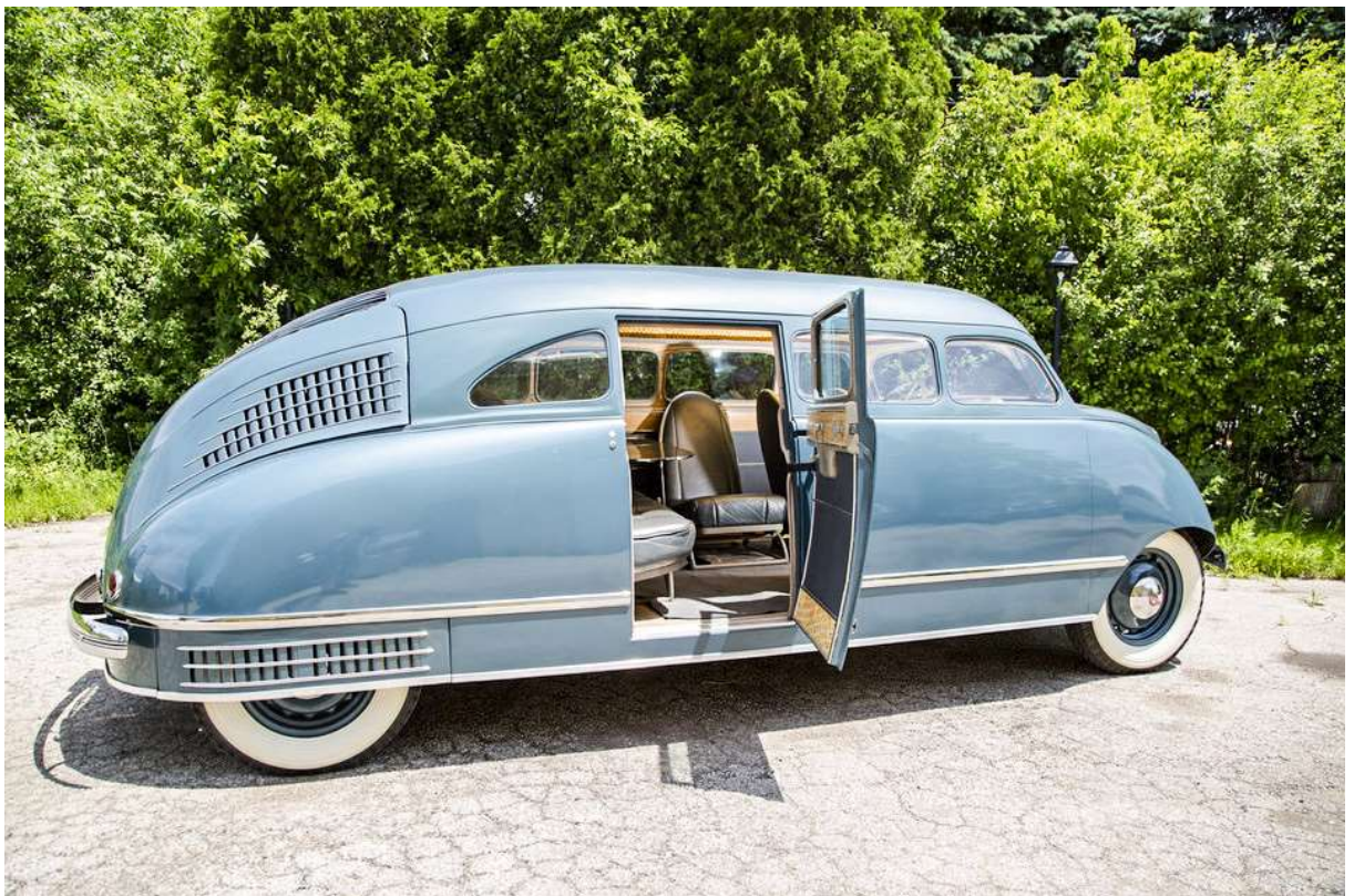
Obrázek 10 - Stout Scarab, první vůz používající sklolaminát [22]
