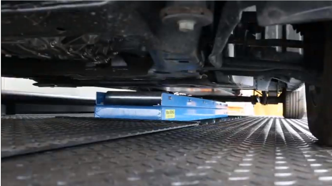
Obrázek 7 Výměna baterie ve stanici společnosti X, z důvodu anonymity není uveden zdroj
