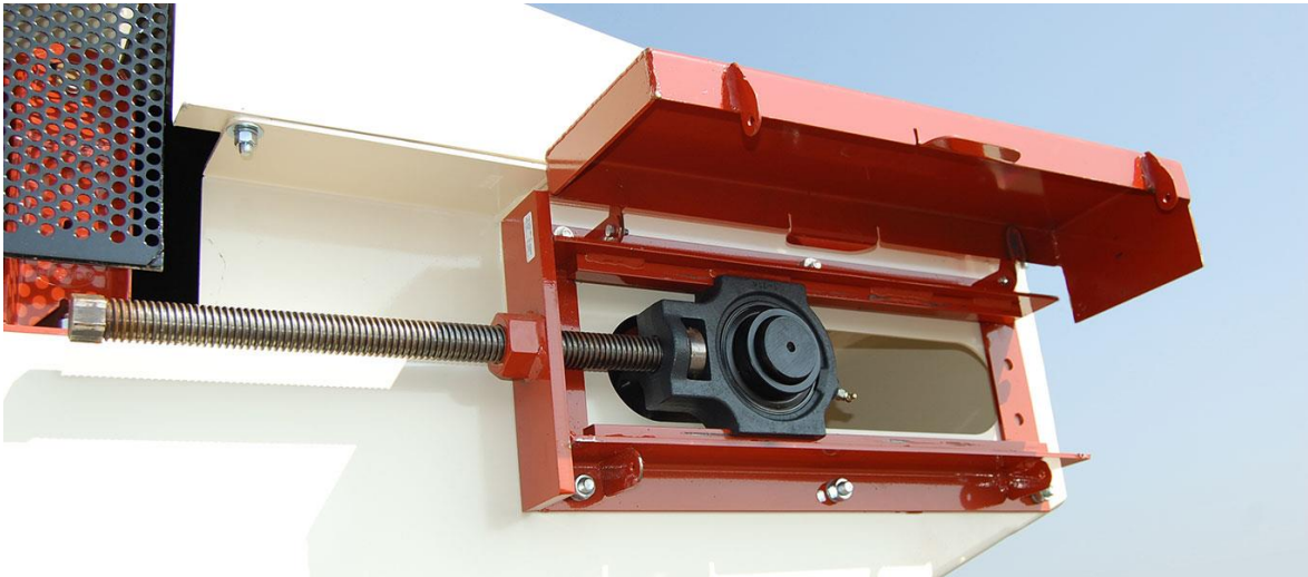
Obr. 13: Tuhé napínání pásu pomocí šroubů [13]
