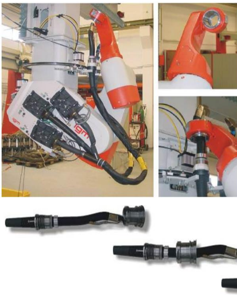
Obrázek 9: Princip výměny hořáku
