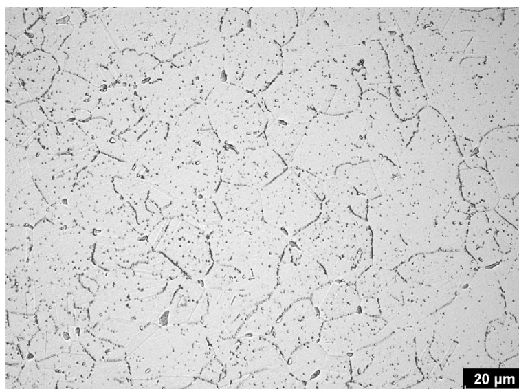
Obrázek 8: EM3 po tepelném zpracování 900 °C/60 min
