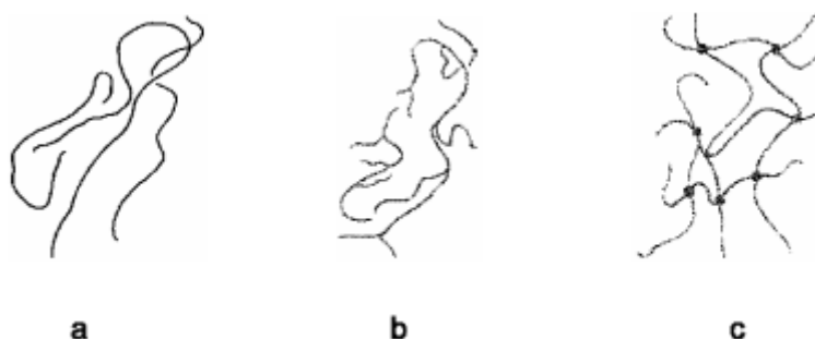
Obr. 1 Struktura makromolekul lineárního (a), rozvětveného (b) a zesíťovaného (c) polymeru. [1]
