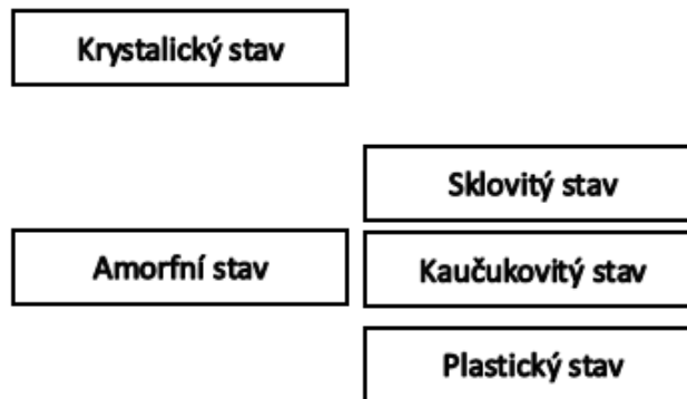
Obr. 3 Schematické rozdělení jednotlivých fází polymeru [6]
