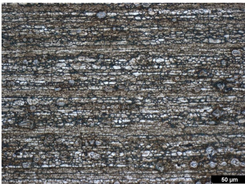
Obr. 68 Lisovaný polotovar po deformaci 20 + 40 % – jádro (podélný řez)
