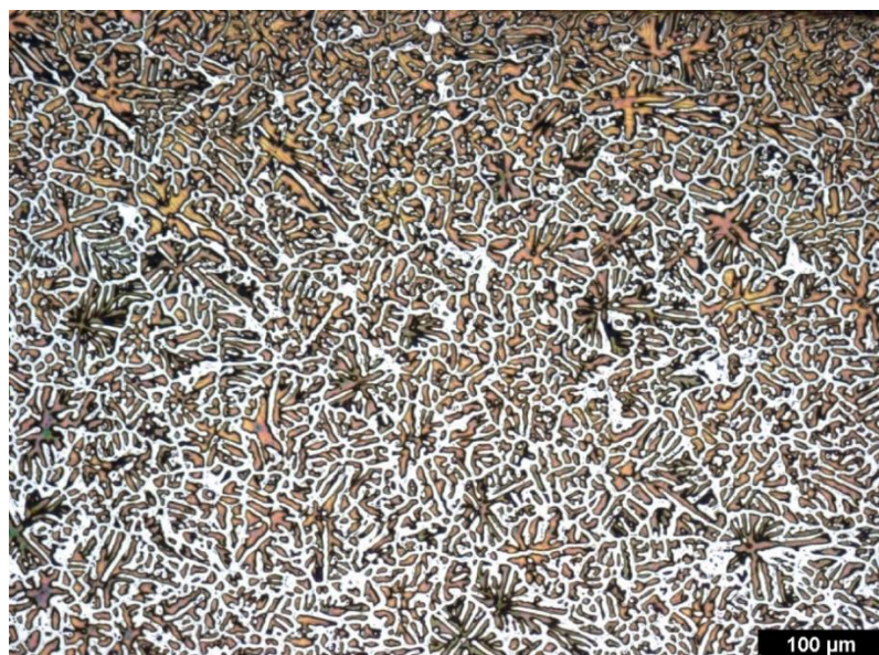
Obr. 70 HCM polotovar ohřátý na kovací teplotu – jádro (podélný řez)
