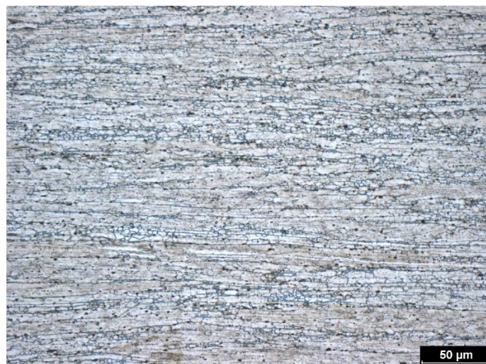
Obr. B 24 Deformace 70 % - jádro (příčný řez)
