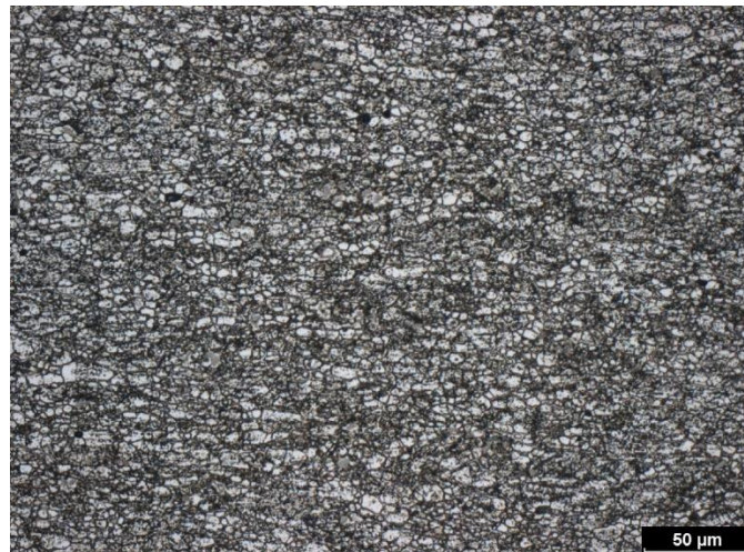
Obr. A 19 Deformace 40 + 20 % - jádro (příčný řez)
