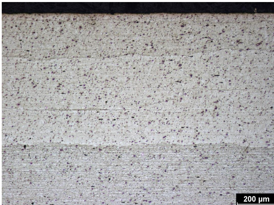
Obr. 84 Přejchod mezi hrubozrnnou rekrytalizovanou vrstvou a jemnozrnnou strukturou jádra
