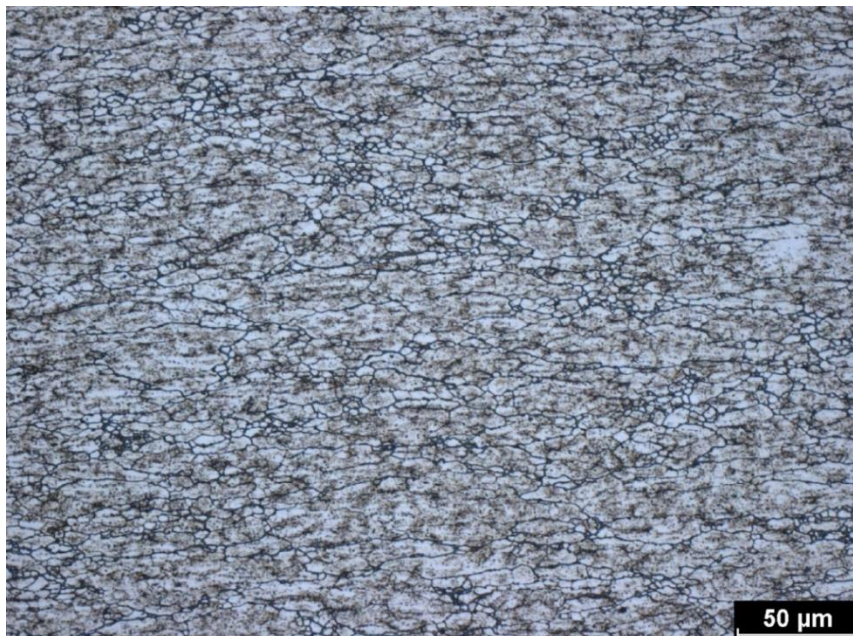
Obr. 72 HCM polotovar po deformaci 20 + 40 % – jádro (podélný řez)
