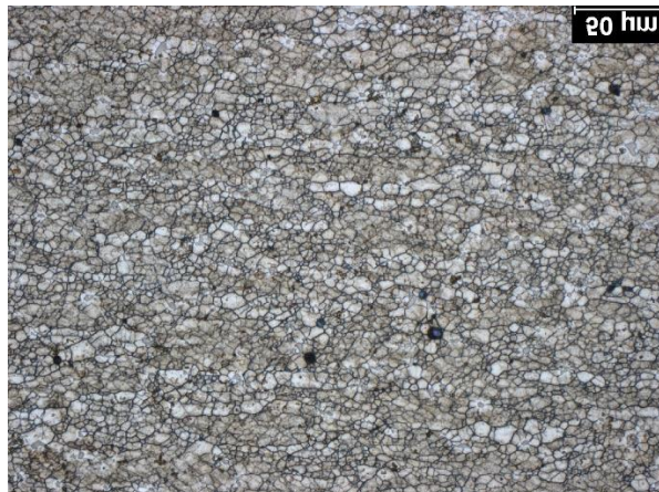
Obr. A 32 Deformace 40 + 20 % s tepelným zpracováním – jádro (podélný řez)
