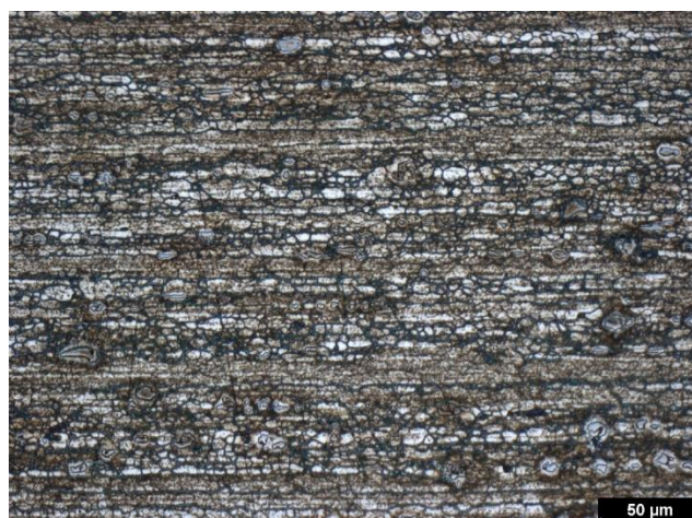
Obr. A 12 Deformace 20 + 40 % - jádro (podélný řez)
