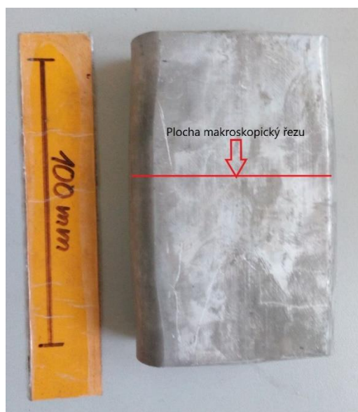
Obr. 52 Znázornění polohy a orientace makroskopického řezu
