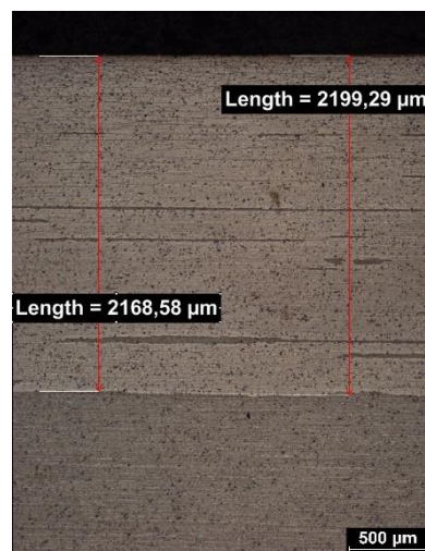
Obr. A 38 Deformace 70 % s tepelným zpracováním – povrch (podélný řez)
