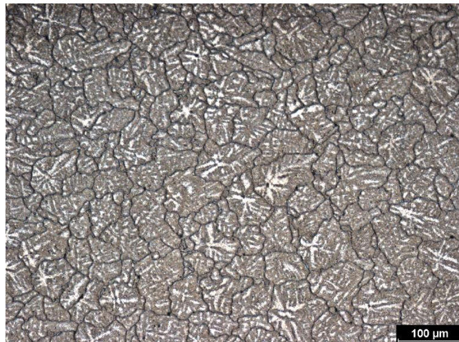
Obr. B 7 Ohřev na kovací teplotu s tepelným zpracováním – jádro (podélný řez)
