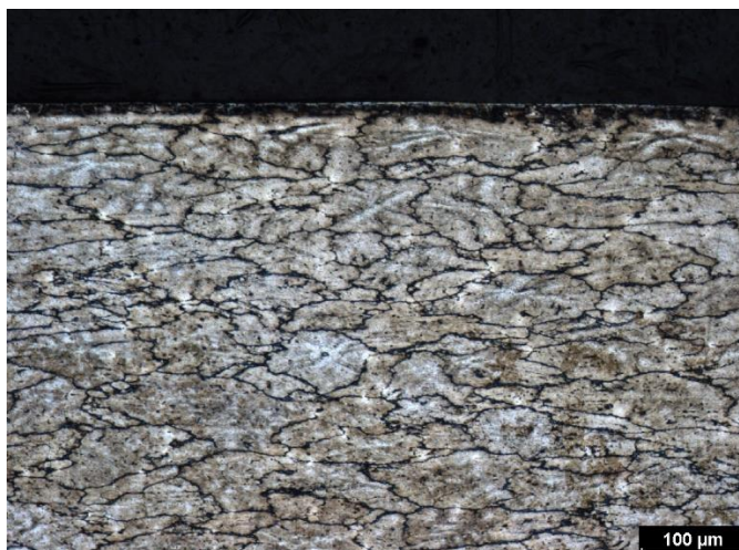
Obr. B 25 Deformace 70 % - povrch (příčný řez)
