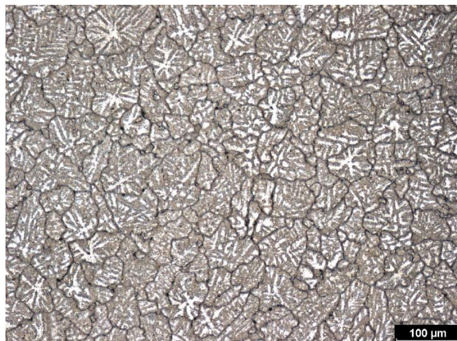
Obr. B 9 Ohřev na kovací teplotu s tepelným zpracováním – jádro (příčný řez)
