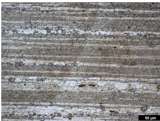
Obr. 66 Lisovaný polotovar ohřátý na kovací teplotu – jádro (podélný řez)
