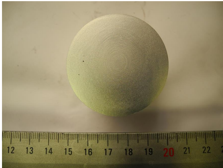
Obr. 54 Makrostruktura, lisovaný polotovár, ohřev na kováčské teploty s tepelným zpracováním
