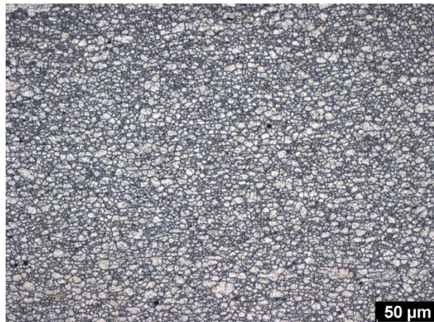
Obr. A 34 Deformace 40 + 20 % s tepelným zpracováním – jádro (příčný řez)
