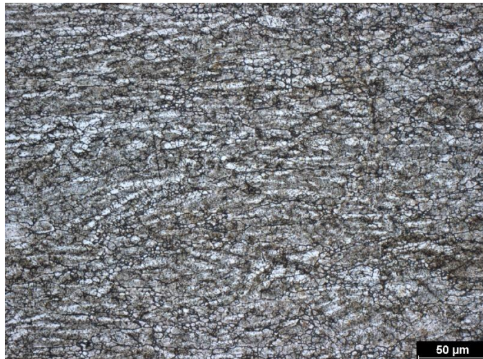
Obr. B 14 Deformace 20 + 40 % - jádro (příčný řez)
