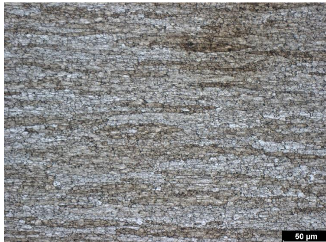
Obr. B 37 Deformace 70 % s tepelným zpracováním – jádro (podélný řez)
