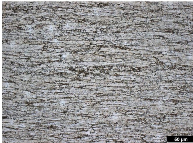
Obr. B 22 Deformace 70 % - jádro (podélný řez)
