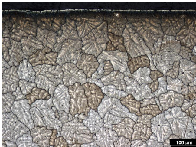
Obr. B 38 Deformace 70 % s tepelným zpracováním – povrch (podélný řez)
