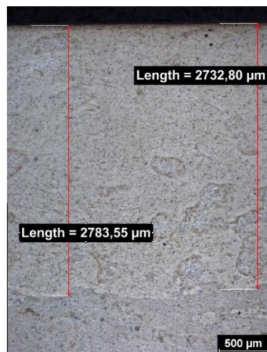
Obr. A 30 Deformace 20 + 40 % s tepelným zpracováním – povrch (příčný řez)
