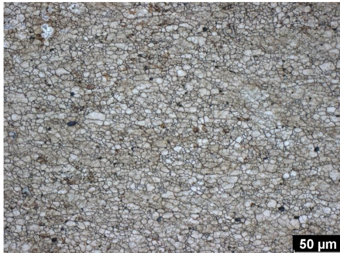
Obr. A 29 Deformace 20 + 40 % s tepelným zpracováním – jádro (příčný řez)
