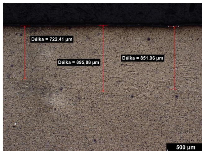
Obr. A 25 Deformace 70 % - povrch (příčný řez)
