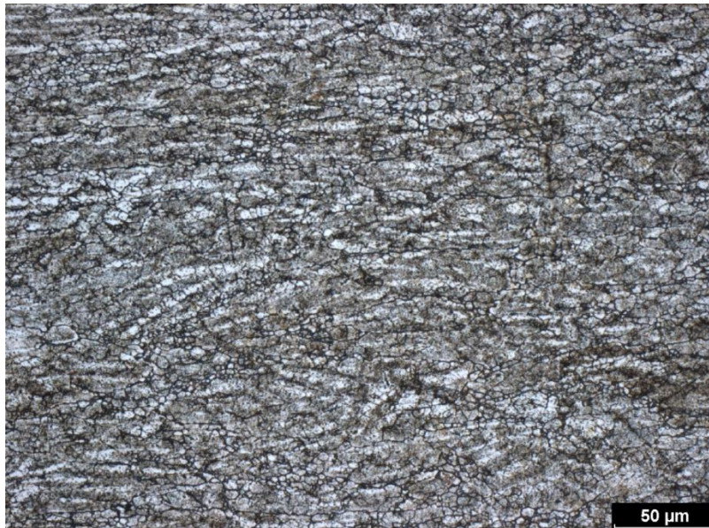
Obr. 76 HCM polotovar po deformaci 20 + 40 % – jádro (příčný řez)
