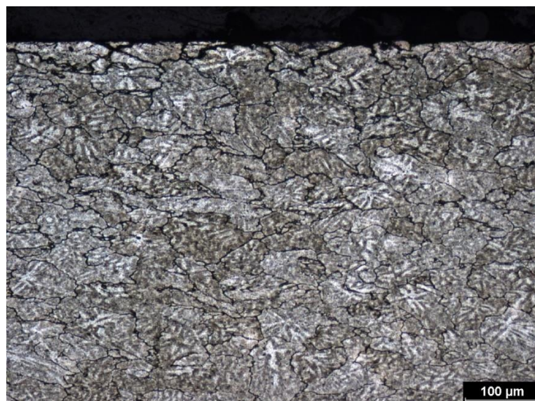
Obr. 88 HCM polotovár po deformaci 40 + 20 % – povrch (podélný řez)
