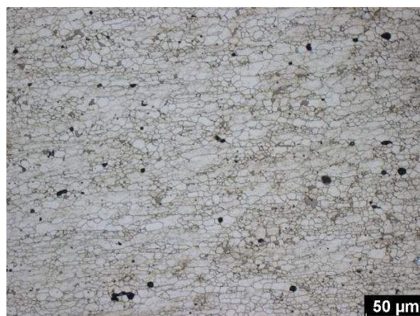
Obr. A 39 Deformace 70 % s tepelným zpracováním – jádro (příčný řez)
