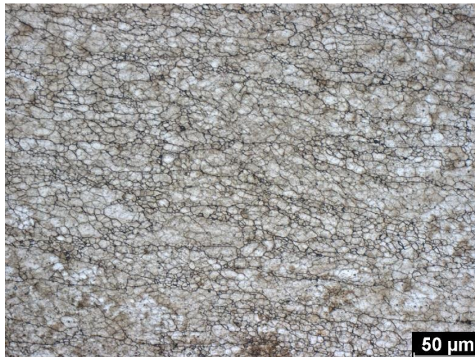
Obr. B 29 Deformace 20 + 40 % s tepelným zpracováním – jádro (příčný řez)
