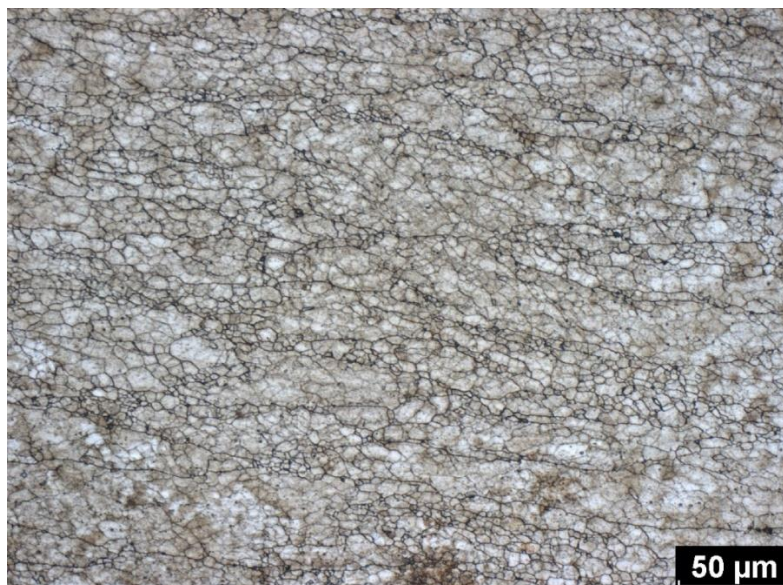
Obr. 77 HCM polotovar po deformaci 20 + 40 % s tepelným zpracováním – jádro (příčný řez)
