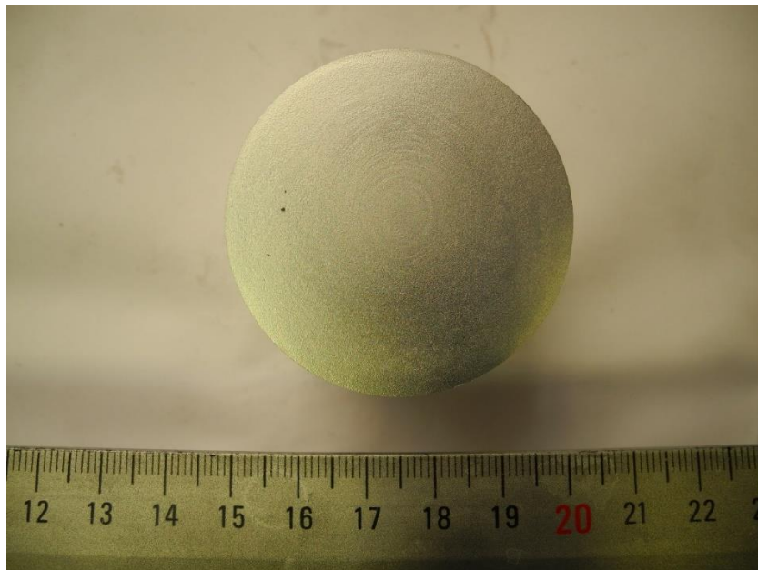
Obr. 60 Makrostruktura, HCM polotovar, ohřev na kovací teplotu s tepelným zpracováním
