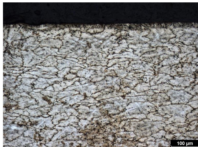
Obr. B 23 Deformace 70 % - povrch (podélný řez)
