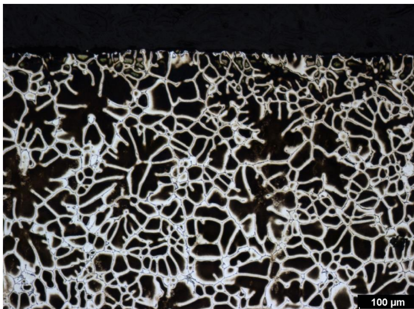
Obr. 90 HCM polotovar ohřátý na kovací teplotu – povrch (příčný řez)
