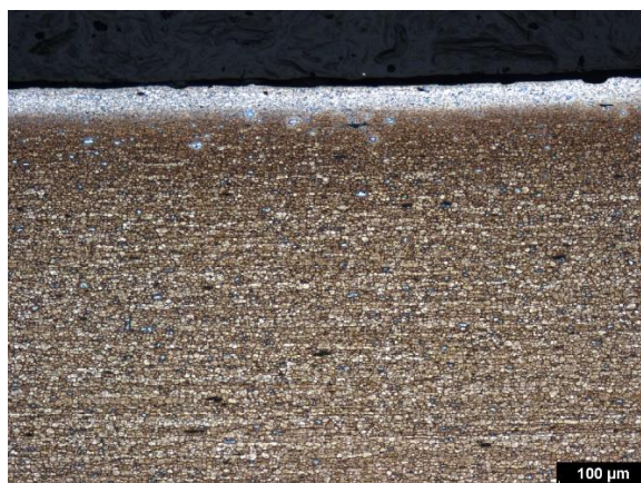
Obr. A 3 Ohřev na kovací teplotu – povrch (podélný řez)
