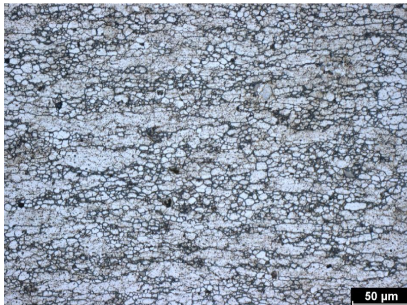
Obr. 74 Lisovaný polotovar po deformaci 20 + 40 % – jádro (příčný řez)
