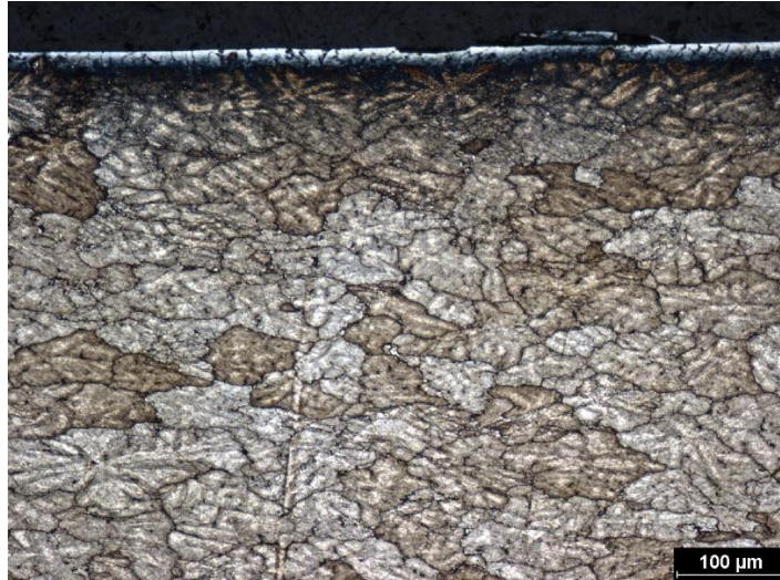
Obr. B 40 Deformace 70 % s tepelným zpracováním – povrch (příčný řez)
