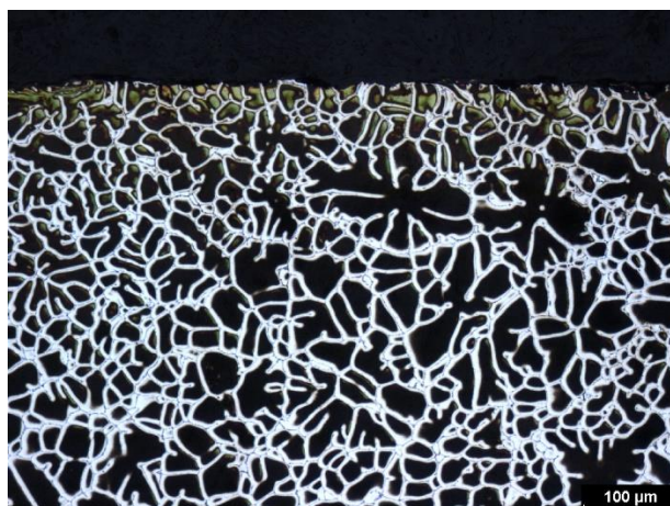
Obr. B 3 Ohřev na kovací teplotu – povrch (podélný řez)
