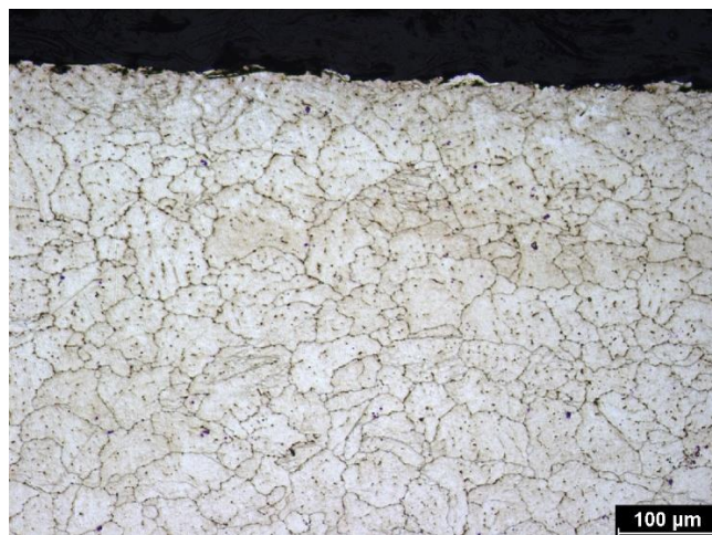
Obr. B 33 Deformace 40 + 20 % s tepelný zpracováním – povrch (podélný řez)
