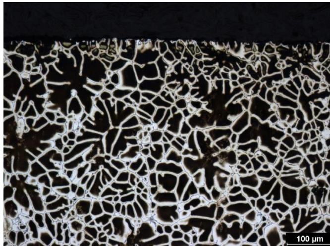
Obr. B 5 Ohřev na kovací teplotu – povrch (příčný řez)
