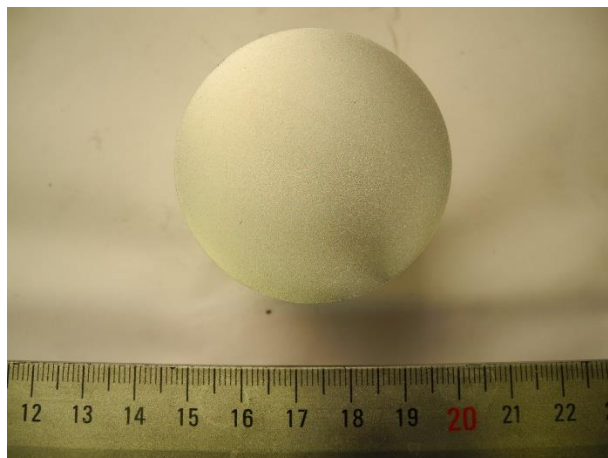
Obr. B 1 Makrostruktura – ohřev na kovací teplotu
