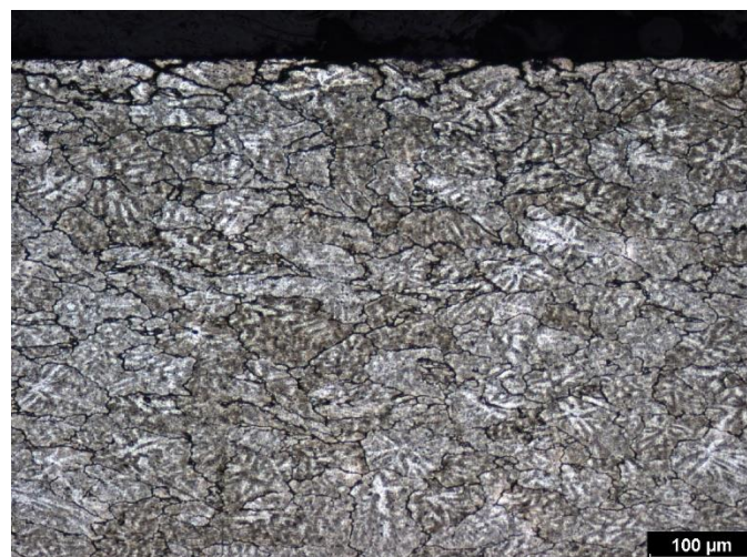
Obr. B 18 Deformace 40 + 20 % - povrch (podélný řez)
