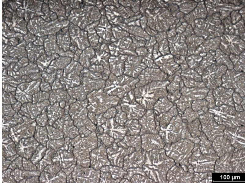
Obr. 71 HCM polotovar ohřátý na kovací teplotu po tepelném zpracování – jádro (podélný řez)
