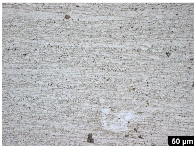
Obr. B 39 Deformace 70 % s tepelným zpracováním – jádro (příčný řez)
