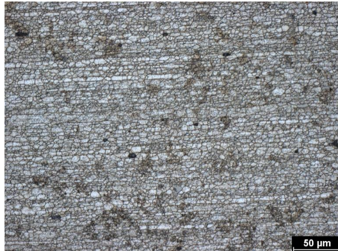
Obr. A 37 Deformace 70 % s tepelným zpracováním – jádro (podélný řez)
