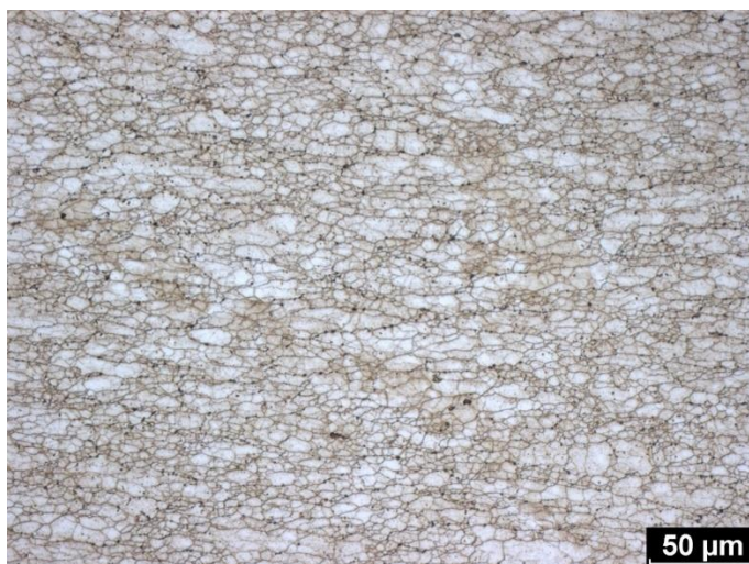
Obr. B 27 Deformace 20 + 40 % s tepelným zpracováním – jádro (podélný řez)
