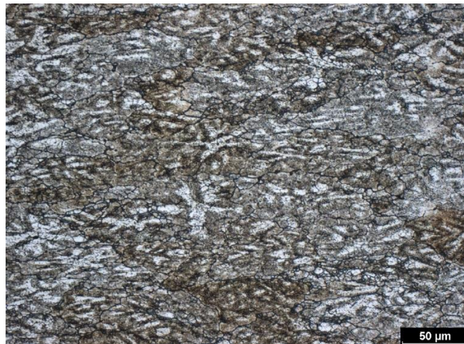
Obr. B 19 Deformace 40 + 20 % - jádro (příčný řez)
