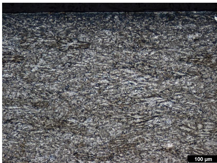
Obr. B 15 Deformace 20 + 40 % - povrch (příčný řez)
