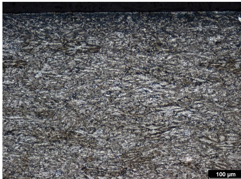
Obr. 92 HCM polotovar po deformaci 20 +40 % – povrch (příčný řez)
