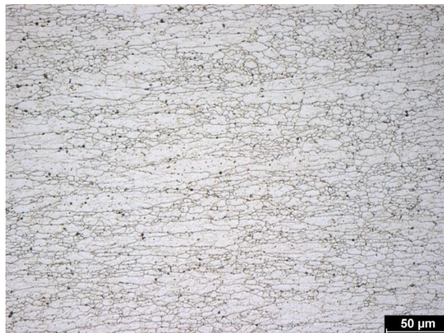
Obr. B 32 Deformace 40 + 20 % s tepelný zpracováním – jádro (podélný řez)
