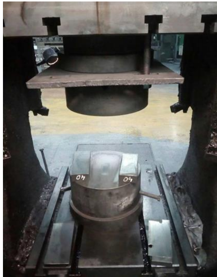
Obr. 42 Pēchovací nástroj s rovnými kovádky
