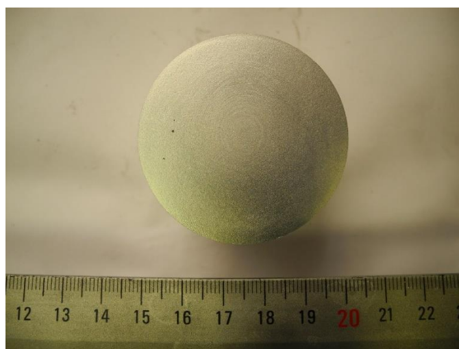
Obr. A 6 Makrostruktura – ohřev na kovací teplotu s tepelným zpracováním
