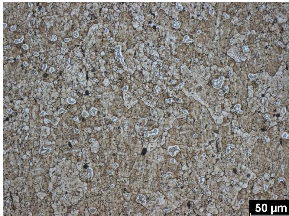
Obr. A 4 Ohřev na kovací teplotu – jádro (příčný řez)
