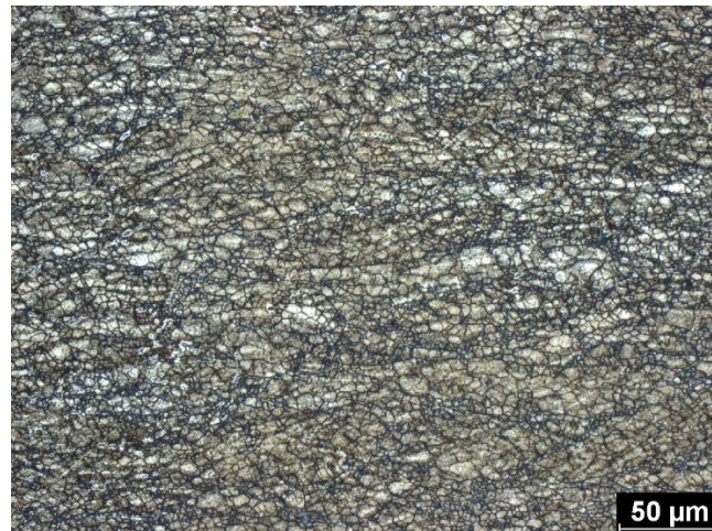
Obr. B 34 Deformace 40 + 20 % s tepelným zpracováním – jádro (příčný řez)
