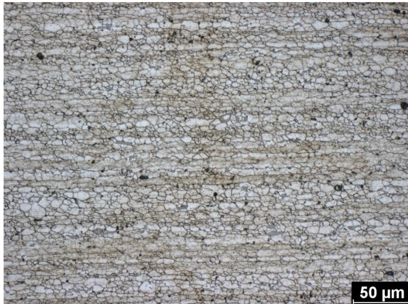
Obr. 75 Lisovaný polotovar po deformaci 20 + 40 % s tepelným zpracováním – jádro (příčný řez)
