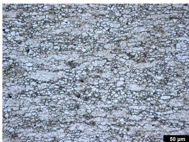
Obr. A 14 Deformace 20 + 40 % - jádro (příčný řez)
