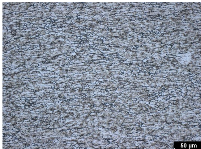
Obr. B 12 Deformace 20 + 40 % - jádro (podélný řez)
