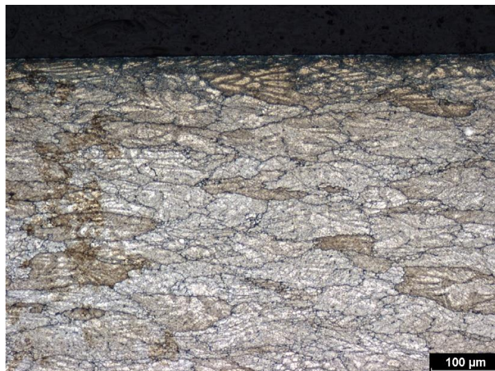
Obr. B 30 Deformace 20 + 40 % s tepelným zpracováním – povrch (příčný řez)
