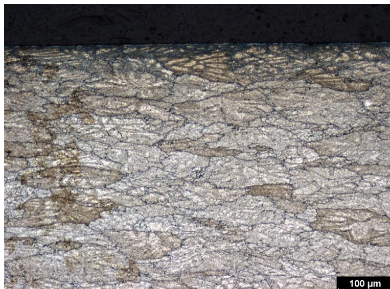
Obr. 93 HCM polotovar po deformaci 20 +40 % s tepelným zpracováním – povrch (příčný řez)
