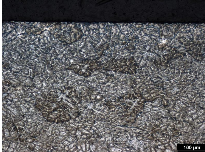
Obr. B 13 Deformace 20 + 40 % - povrch (podélný řez)
