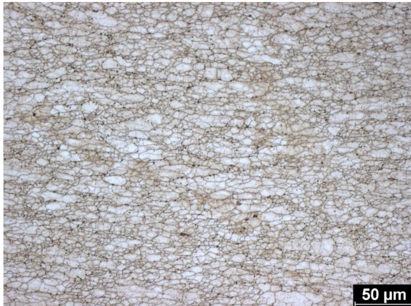
Obr. 73 HCM polotovar po deformaci 20 + 40 % s tepelným zpracováním – jádro (podélný řez)
