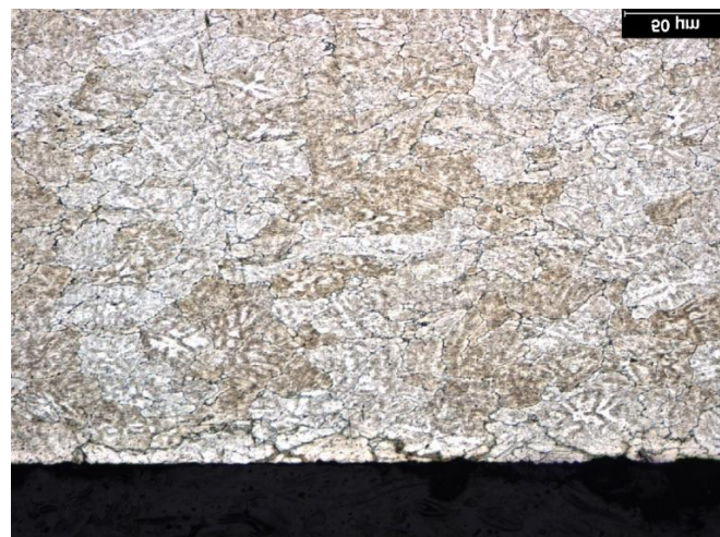
Obr. B 20 Deformace 40 + 20 % - povrch (příčný řez)
