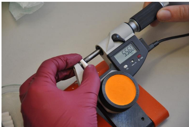
Obrázek 15 - Měření vzorku před zatížením
