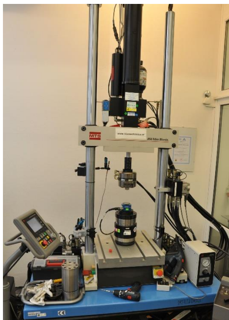
Obrázek 7 - Zatěžovací systém MTS Mini Bionix 858.02
