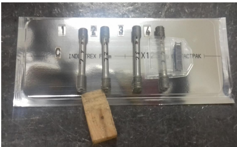
Obrázek 15: Vzorky připravené k pořízení rentgenového snímku
