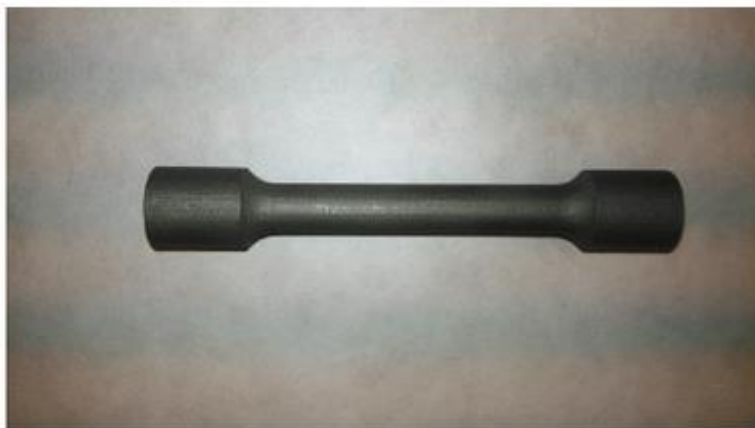
Obrázek 7: vzorek z oceli AISI 316L pro porovnání mechanických vlastností 3D tištěných výrobků oproti za tepla tvářeným [20]
