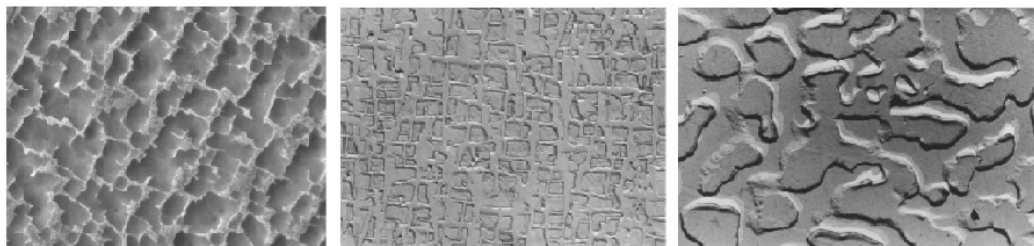
Obrázek 7: Fáze \gamma' ve tvaru krychlí a zhrublé částice po přehřátí
