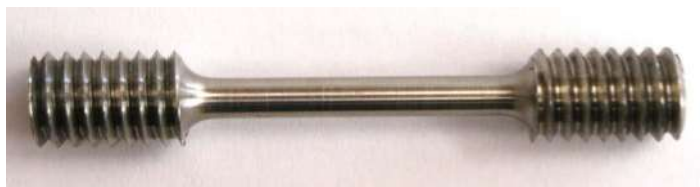
Obrázek 10: Zkušební vzorek pro zkoušku tahem ( d_0=6 mm, L_0=30 mm)
