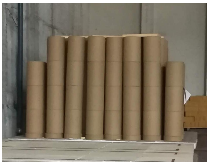
Obr. 15: Pecní vůz s komínovými vložkami
