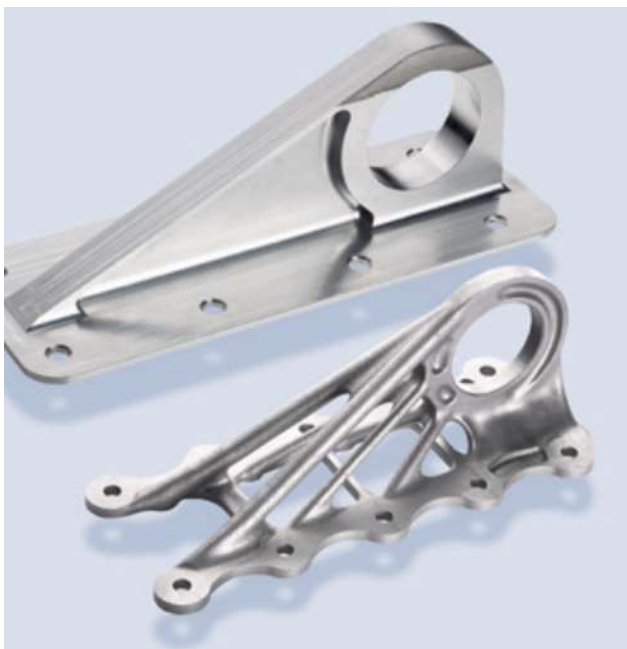
Obrázek 4- Obráběná součástka (nahore), součástka vyrobená pomocí SLM (dole) [6]
