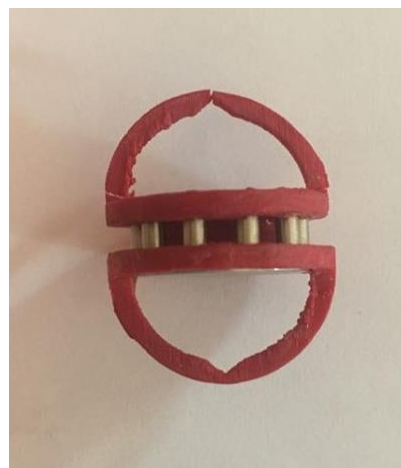
Obr. 25: Přípravek pro testování magnetického spojení
