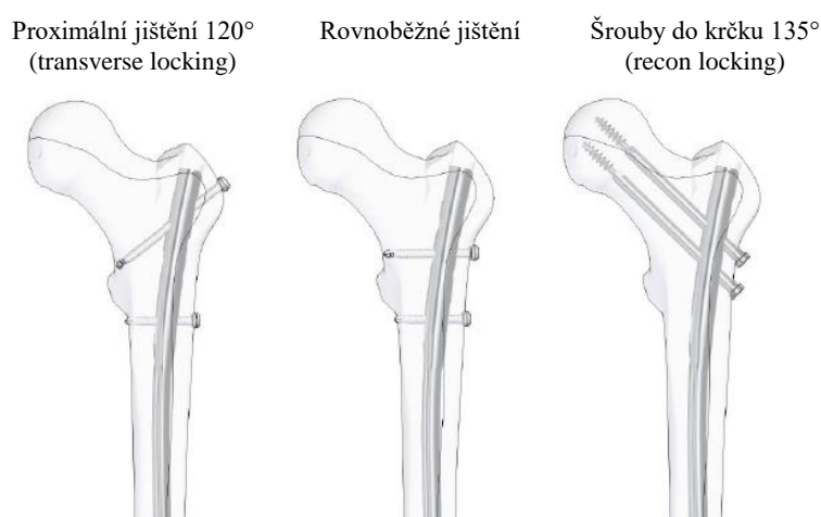
Obrázek 19 – Možnosti proximálního jistění femorálního laterálního hřebu [7]
