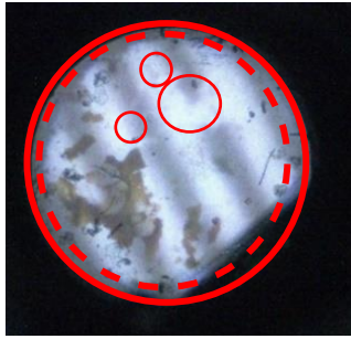
Obrázek 48 Obraz rastru po protažení, Vlákno 1. Červeně čerchované – zmenšený aktivní průměr schopný přenosu. Tence červené – porušení uspořádání vláken.
