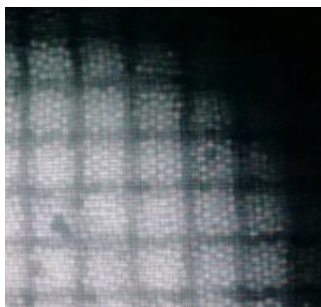
Obrázek 13 Pohled na výstupní průřez optického vlákna s rastrovým obrazem přes kameru
