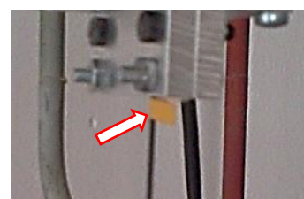
Obrázek 40 Poloha vložky pro pozorování vyklouznutí
