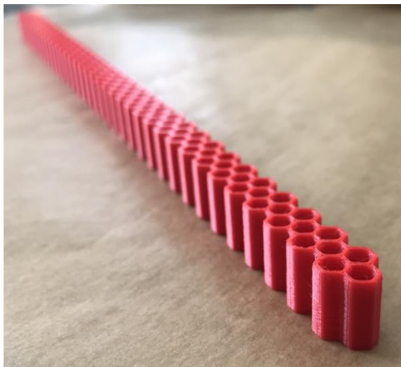
Obr. 22 Vyrobená voština pomocí 3D tisku (vzorek pro sadu č. 4)
