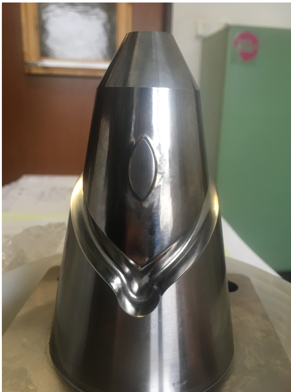
Obr. 6.3 Detail profilu rozvodu taveniny. [autor]
