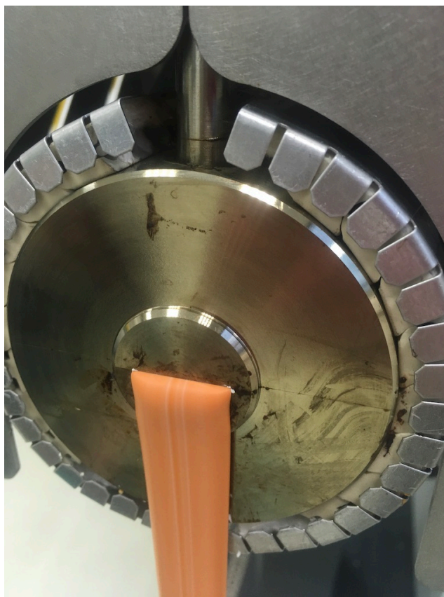
Obr. 9.7 Detail na kapiláru vytlačovací hlavy a vytlačovaný polyethylen s příměsí HFFR [autor]
