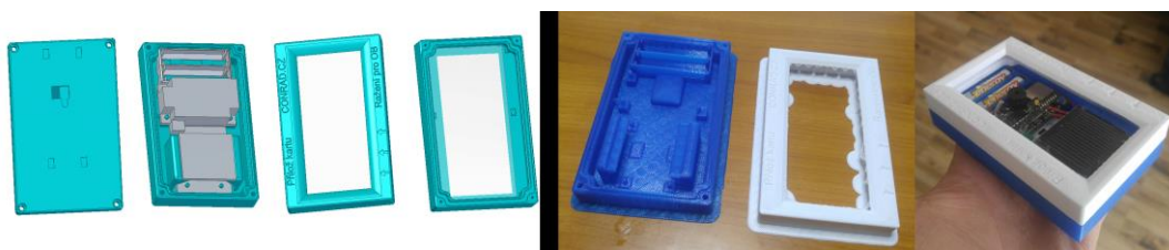
Obr. 20 Krabička: 3D návrh dolní a horní části, Vytisknuté obě části, Hotová krabička
