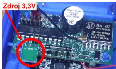
Obr. 29 Osazená DPS zařízení KS s vyznačeným modulem DC-DC měniče
