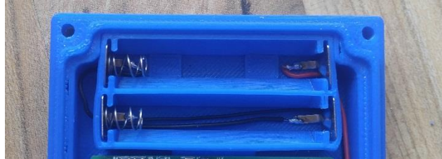
Obr. 28 Zdeformovaná stěna držáku baterií po závodě
