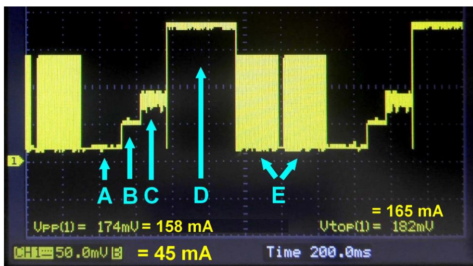
Obr. 27 Průběh odběru elektrického proudu zařízení KS na osciloskopu (R = 1,1Ω)
