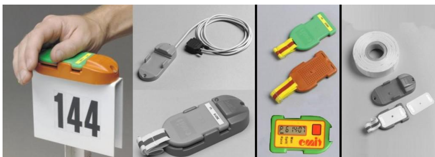
Obr. 3 Emit: Průběh ražení kontroly, Karty pro závodníky, Záložní systém, zdroj [5]
