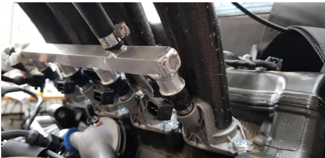
Obr. 18 – Zástavba nových vstrekovačov na motore Yamaha R6 tímu CTU CarTech
