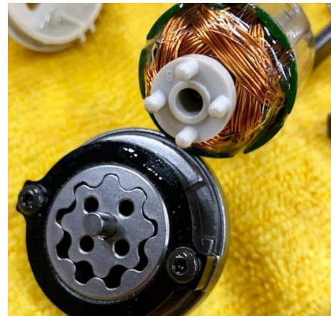
Obr. 9 – Mechanizmus výstredníkového čerpadla Walbro GSL [10]
