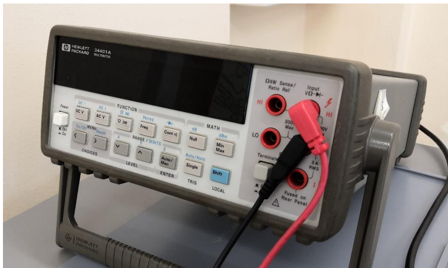
Obr. 19 Digitální multimetr použitý na měření elektrického odporu
