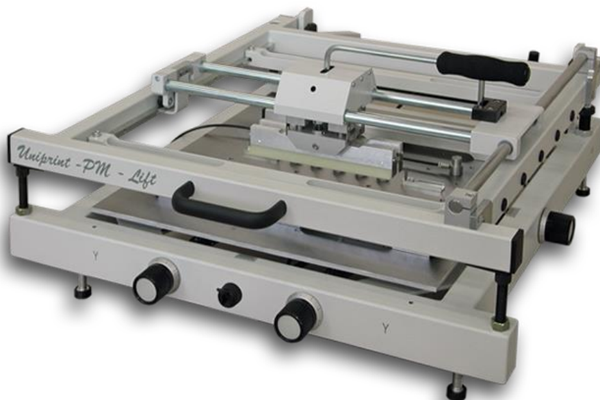
Obr. 5: Ukázka ručního zařízení pro sítotisk [7]
