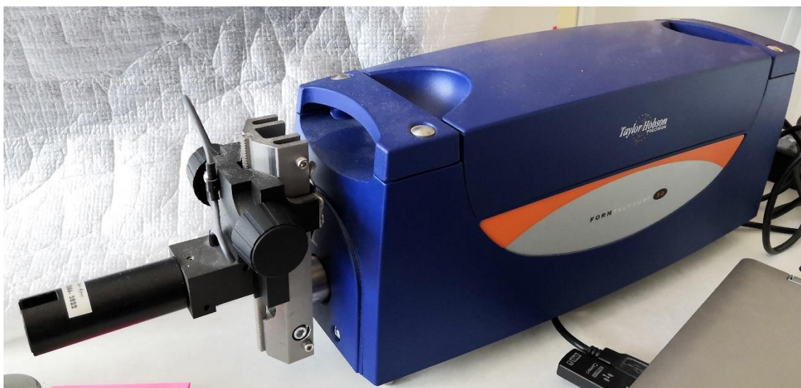
Obr. 44 Přístroj na měření tloušťky vrstev
