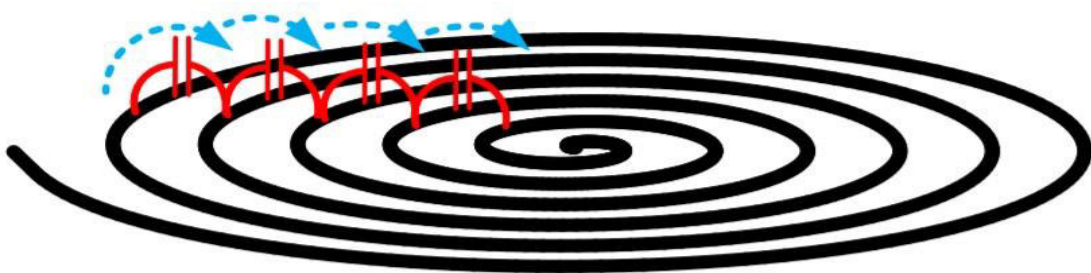
Obrázek 12 Parazitické kondenzátory v induktoru [Zdroj: [2]]
