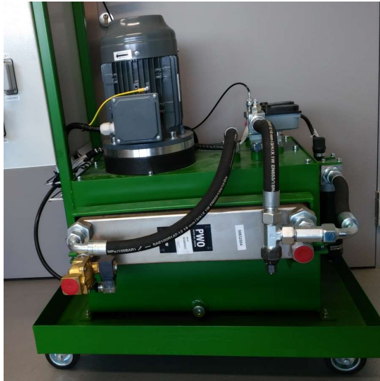
Obr. 40: Hydraulický agregát od Seall s.r.o. (pohled na chladič)
