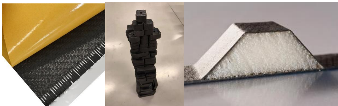
Obrázek 38 a) Prepreg SIGRAPREG Zdroj: https://shop1.r-g.de/art/CS-200120-T-PP ; b) Ertalon Zdroj: Vlastní; c) Rohacell Zdroj: http://www.emkayplastics.co.uk/emailshots/mar-15-newsletter/index.html
