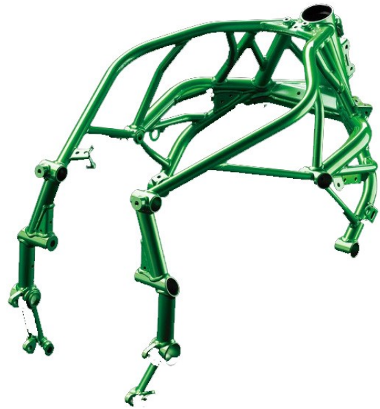
Obr. 15 Rám motocyklu Kawasaki Ninja H2R (2015)- lehký Dvojitý trubkový mřížový rám těsně obepínající blok spalovacího motoru
