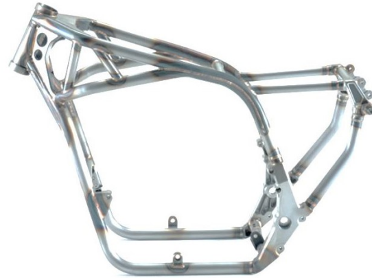
Obr. 18 Kolébkový dvojitý rám stroje KAWASAKI Z1
