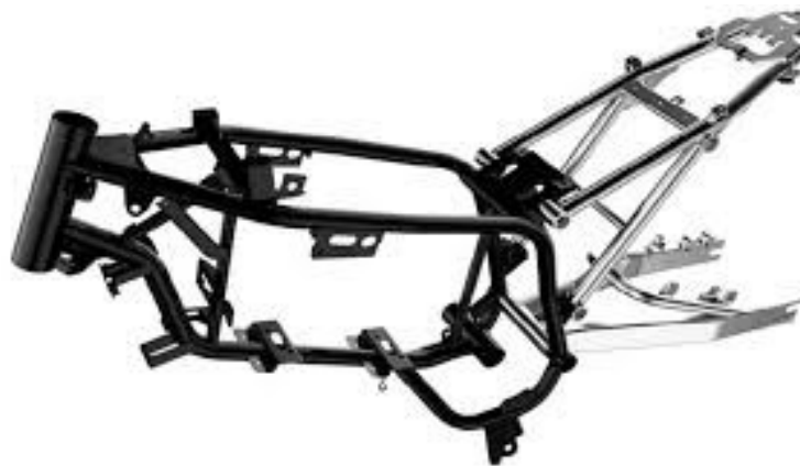
Obr. 31 Rám stroje SuperSOCO TS
