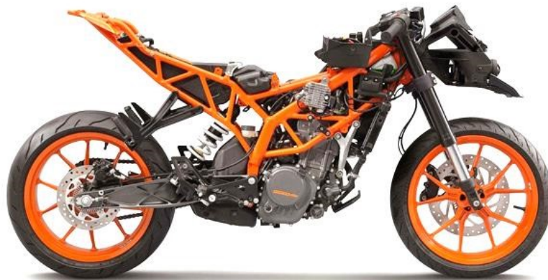
Obr. 16 Příhradový rám stroje KTM
