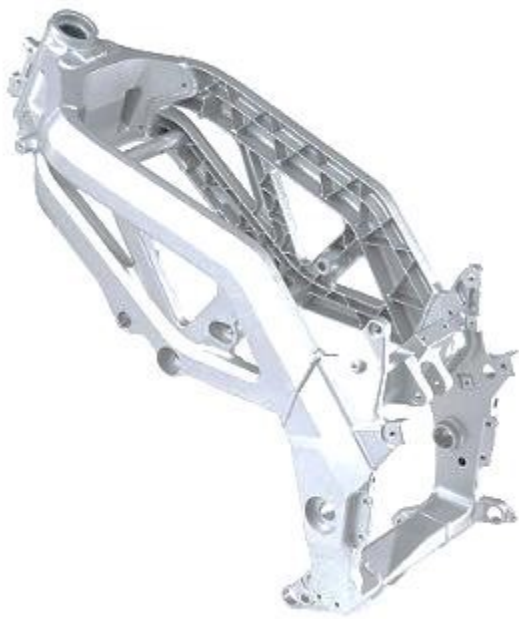
Obr. 14 Dvojitý otevřený odlévaný rám Suzuki na boční části je vidět triangulace rámu zajišťující tuhost
