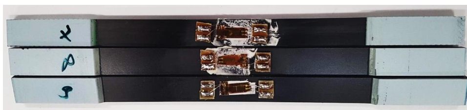
Obr. 5.5 - Zkušební vzorky osazené tenzometry
