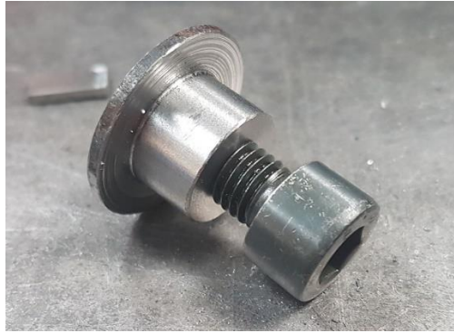
Obr. 7.5 - Vložka pro snadné rozebrání formy
