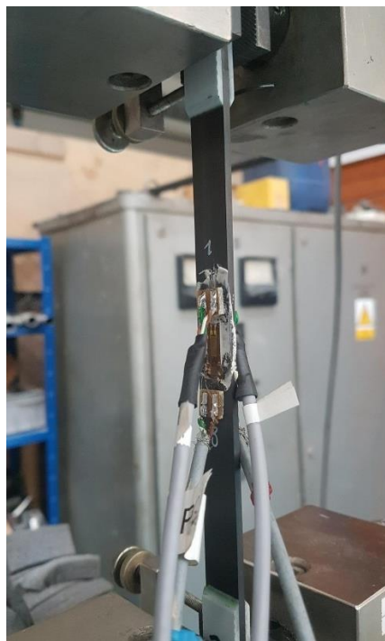
Obr. 5.7 - Testovaný vzorek ve zkušebním zařízení a zapojenými tenzometry
