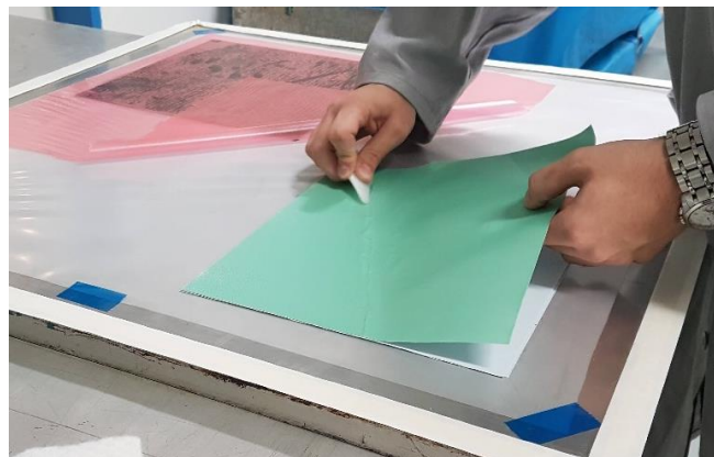
Obr. 5.3 - Proces vrstvení skelného kompozitu
