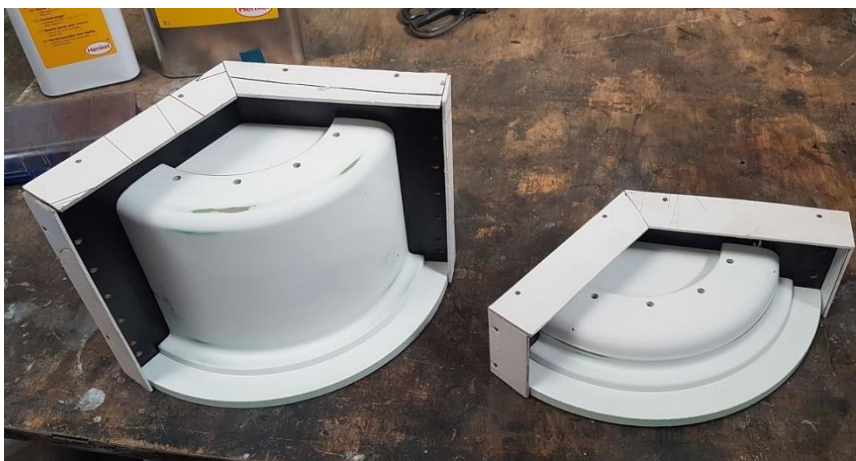
Obr. 7.3 - „Meziforma“ před laminací
