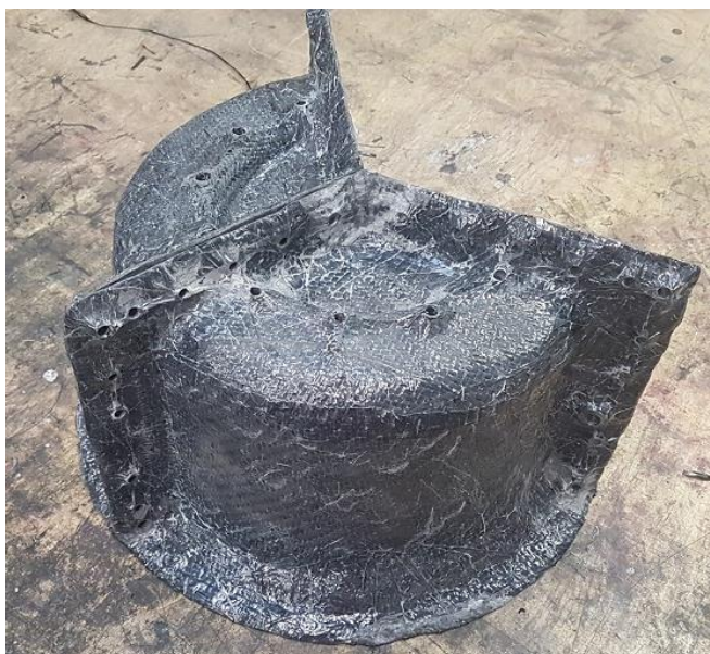
Obr. 7.4 - Dvě části finální formy vnějšího límce
