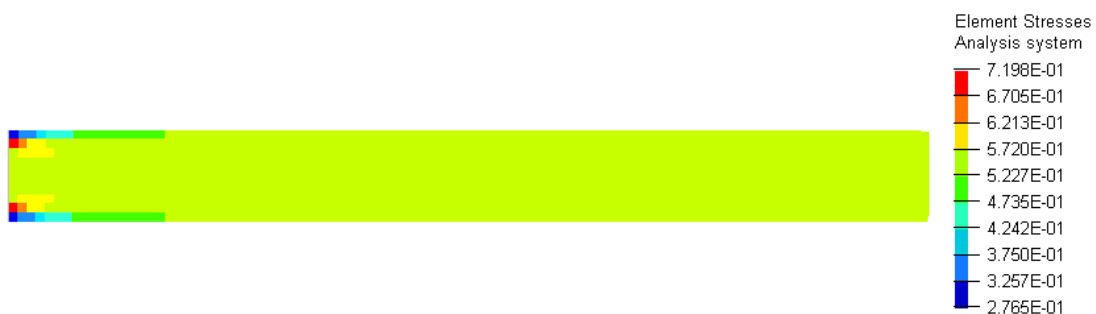
Obr. 6.4 - Vyobrazení napětí při simulaci zkoušky tahem
