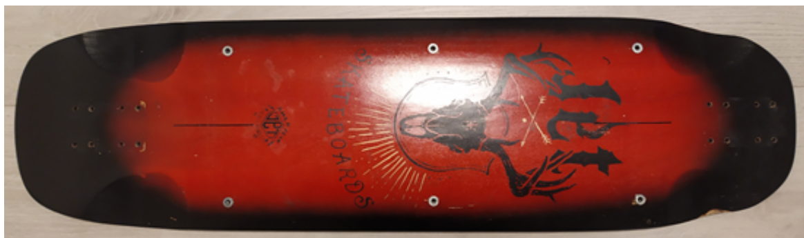
Obr. 56 Zašroubování závrtných matic do desky
