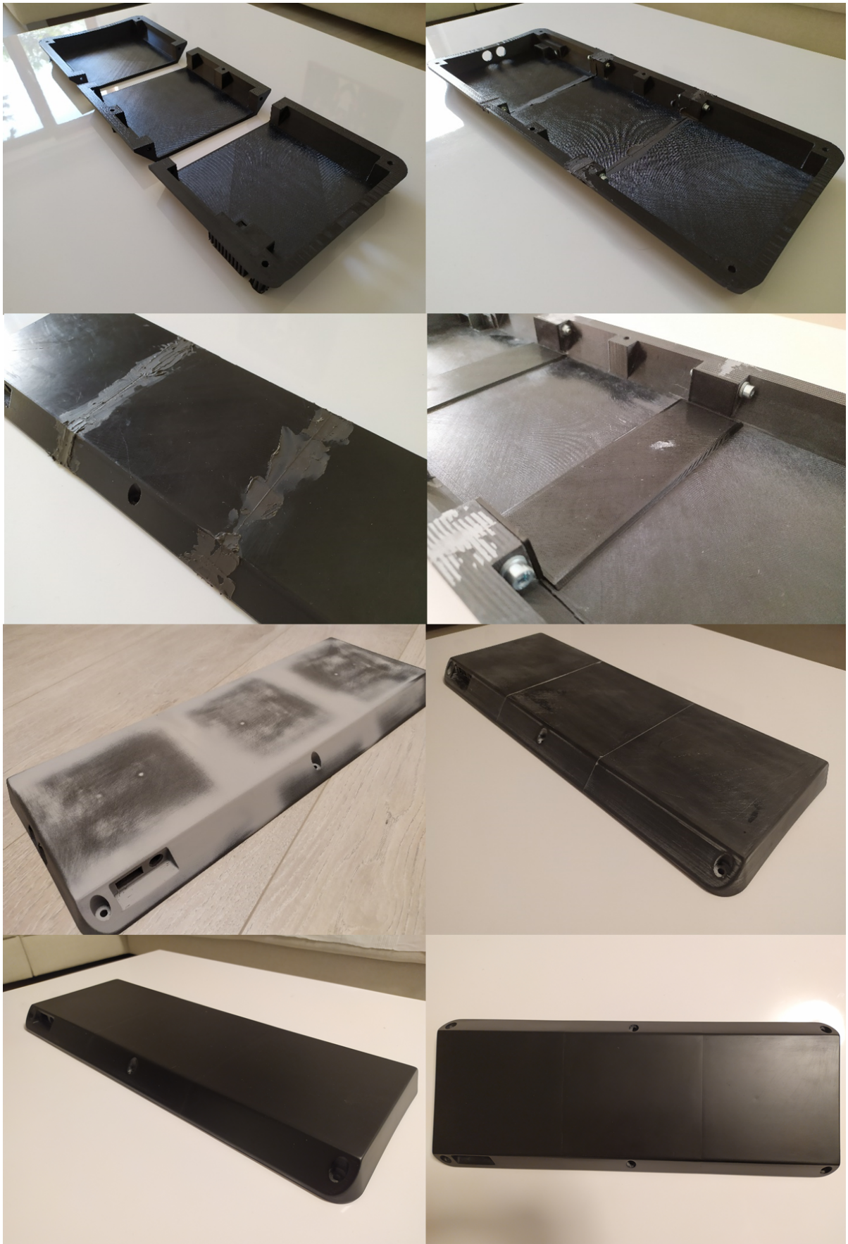
Obr. 54 Dokončovací operace krytu elektrických komponent
