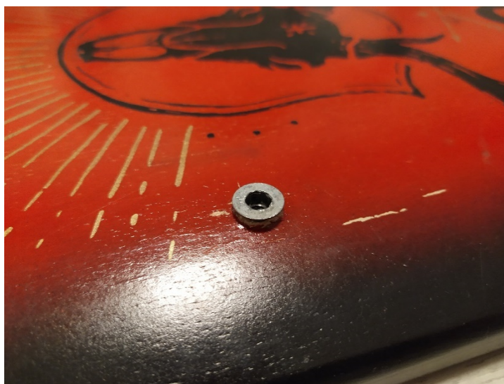
Obr. 58 Detailní pohled na závrtnou matici v desce
