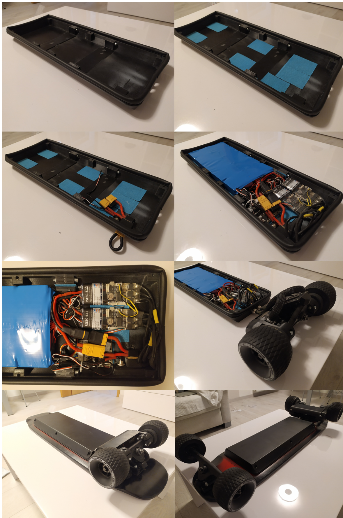
Obr. 59 Umístění komponent do krytu elektrických komponent a montáž pohonného ústrojí
