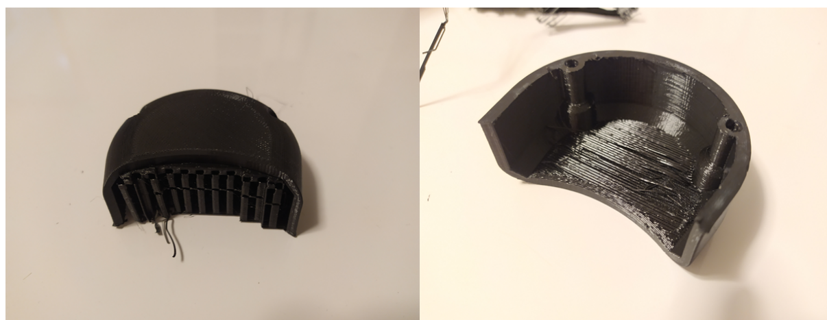
Obr. 53 Odstranění technologických podpor u krytky řemenice
