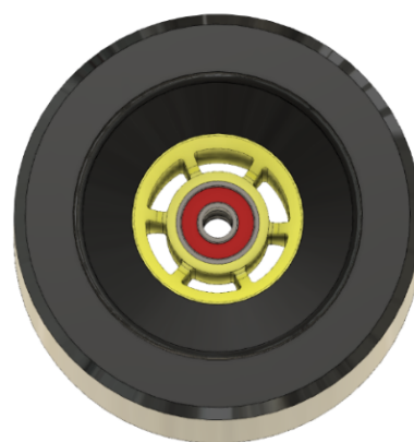
Obr. 27 Kolečko s jádrem typu ABEC11
