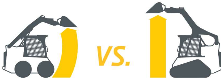
Obrázek 7: Porovnání radiálního a vertikálního zdvihu [10]
