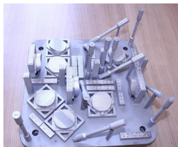
Obr. 16: vytištěná paleta, zeleně zvýrazněné M04 tištěný ve vodorovné poloze a artefaktu MS03 tištěný ve svislé poloze (na levém obrázku) [9]
