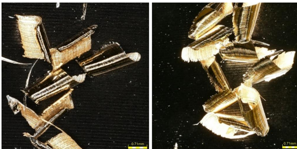
Obr. 12: porovnání třísek, tištěný polotovar (vlevo), výkovek (vpravo) [9]
