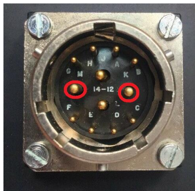
Obrázek 41 - Napájecí piny motoru
