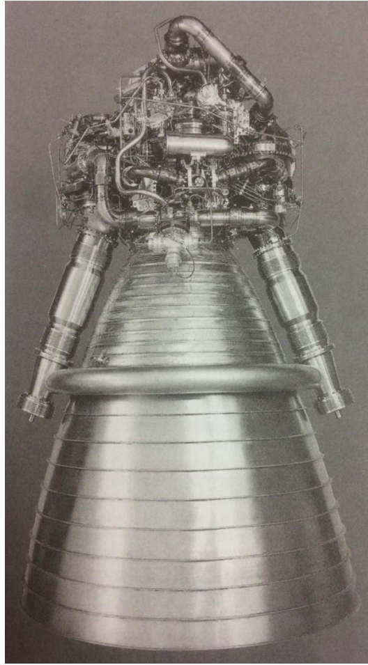
Obrázek 7: Raketový motor na kapalné pohonné hmoty [1]
