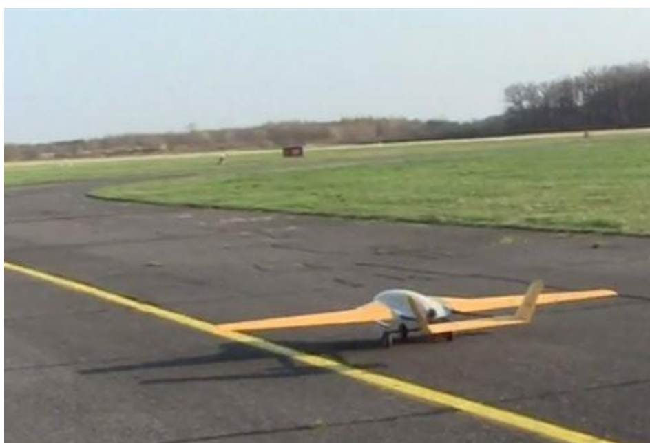
Obrázek 2 - UAV se rozjíždí s odhazovacím podvozkem; snímek z videa; archiv Ústavu letadlové techniky
