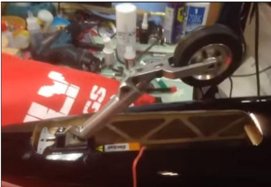
Obrázek 13 - Předový podvozek modelu stíhačky s rozpojitelným převodem; snímek z videa [6]
