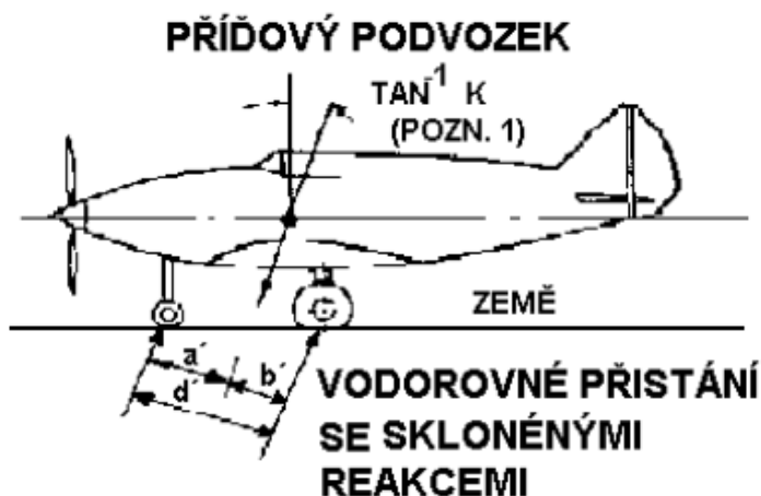
Obrázek 17 - Vodorovné přistání na tři body; [1], dodatek C
