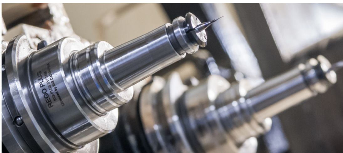
Obrázek 22 - Upnutí mikrovrtáku pomocí hydraulického upínače [14]
