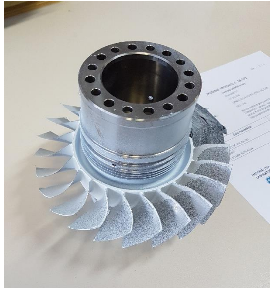
Obr. 6.7: Kuličkováná odtoková hrana kola č.1
