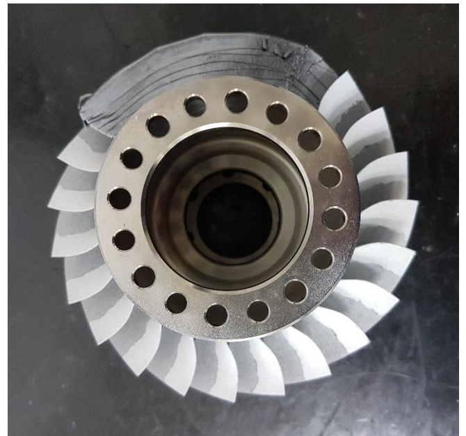
Obr. 6.9: Kuličkováná odtoková hrana kola č.3
