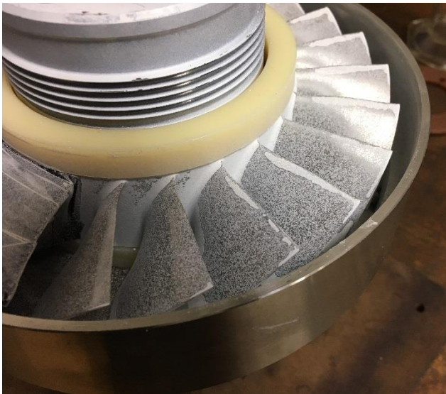
Obr. 6.8: Kuličkováná náběžná hrana kola č.1
