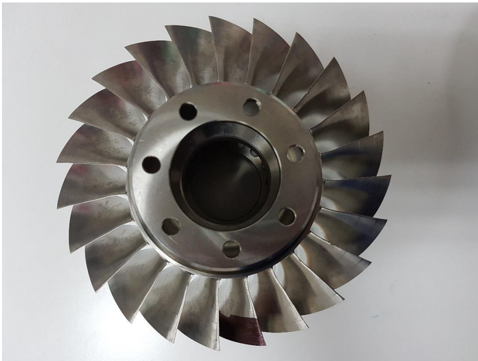
Obr. 6.17: Lopatkové kolo č.2 před kuličkováním
