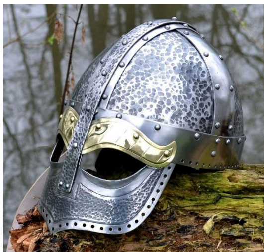
Obrázek 3.1: Helma zpevněná a vytvrzená mechanickým zpracováním povrchu [52]
