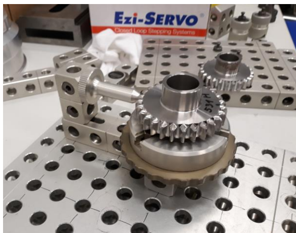
Obrázek 38: 1. Verze upnutí ozubeného kola
