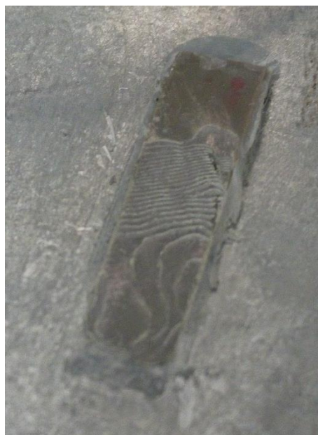
Obr. 3-8 Částečně obroušený povrch piezoaktuátoru. Čáry, připomínající letokruhy, jsou jednotlivé vrstvy zmíněných piezoprvků.
