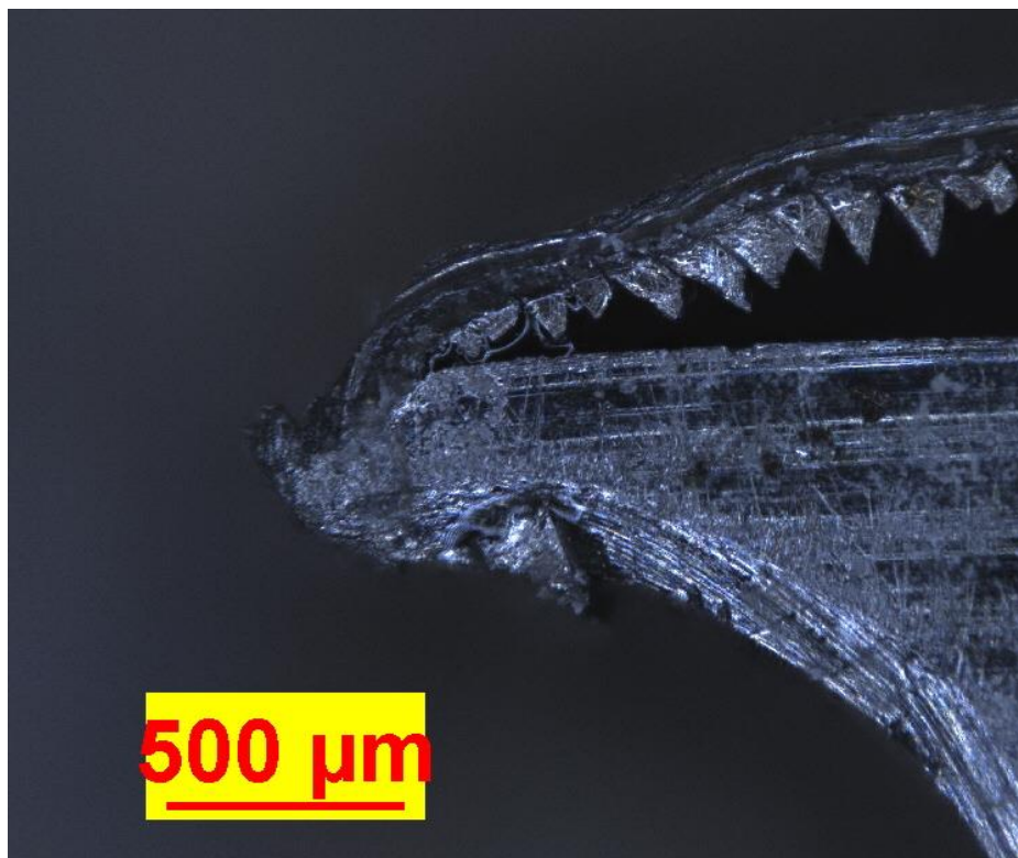
Obrázek č. 60: Kořen třísky při druhém přerušení (zvětšený 80x).
