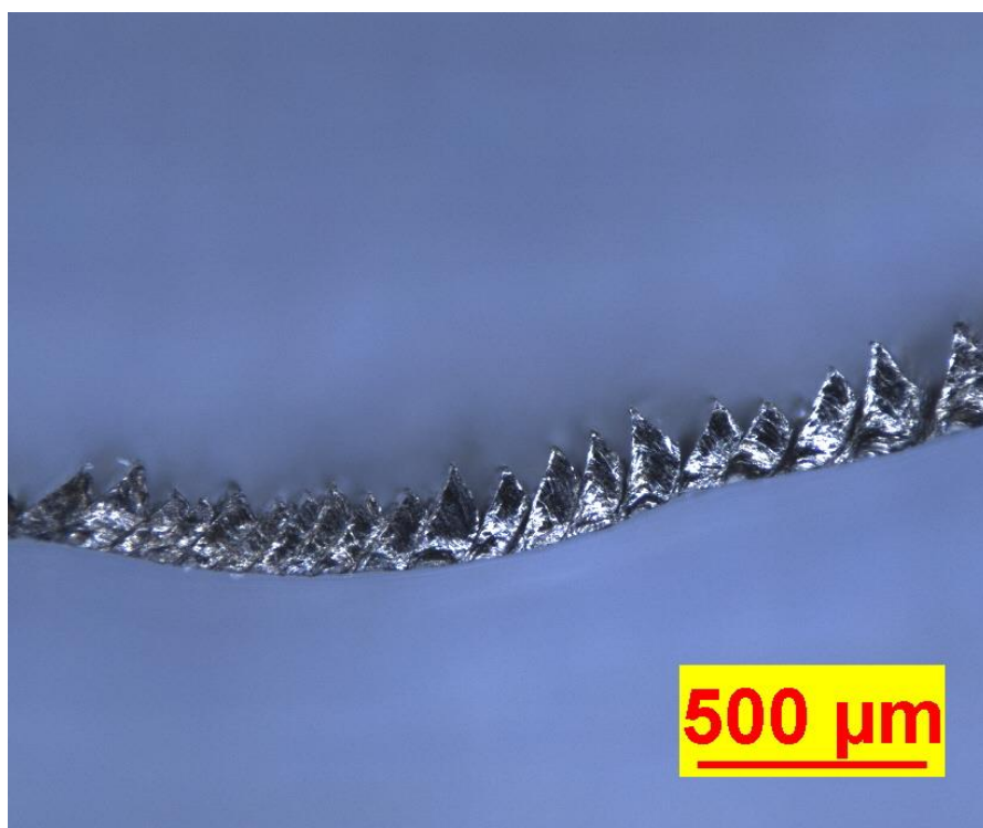
Obrázek č. 58: Snímek utvářené třísky (80x zvětšení).
