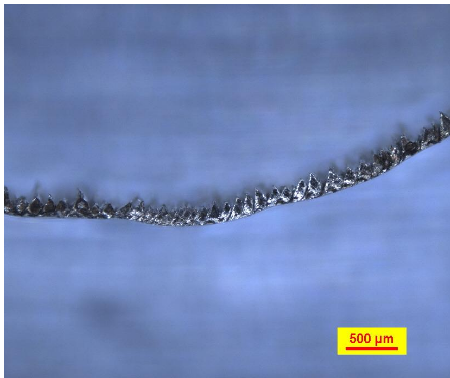
Obrázek č. 57: Snímek utvářené třísky (zvětšení 40x).
