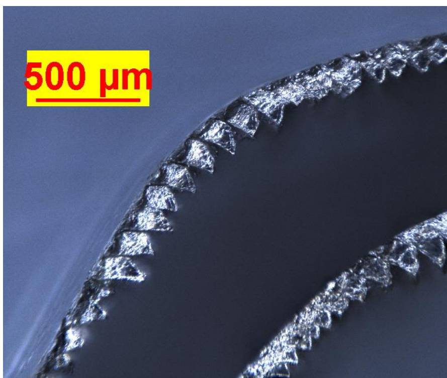
Obrázek č. 66: Tříška vznikající při 45 m/min (zvětšení 80x).
