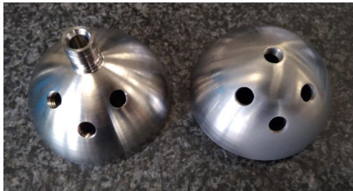
Obrázek 10.1 - Porovnání nedokončeného a standardního pláště
