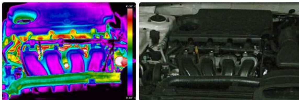
Obr. 3.10: Termovizní pohled (vlevo) a pohled bez termovizní kamery (vpravo) na spalovací motor. [12]
