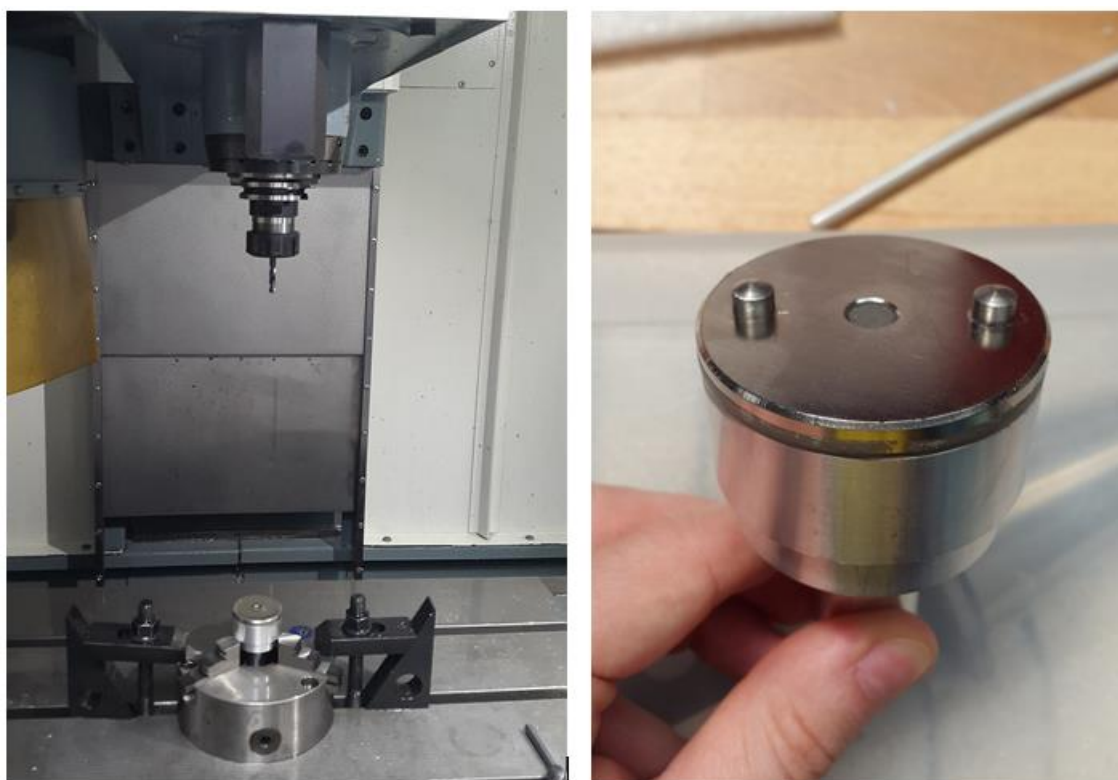
Obrázek 19: Vrtání neodýmového magnetu a usazení kolíčků
