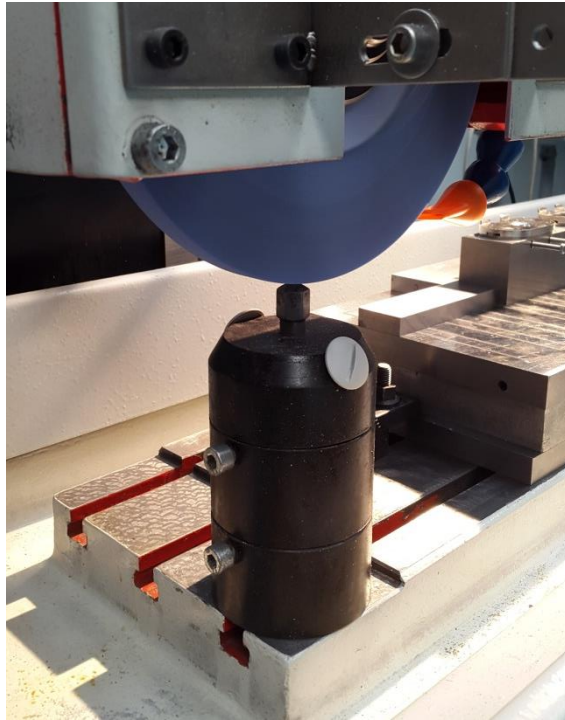
Obrázek 23: Průběh orovnávaní brusného kotouče
