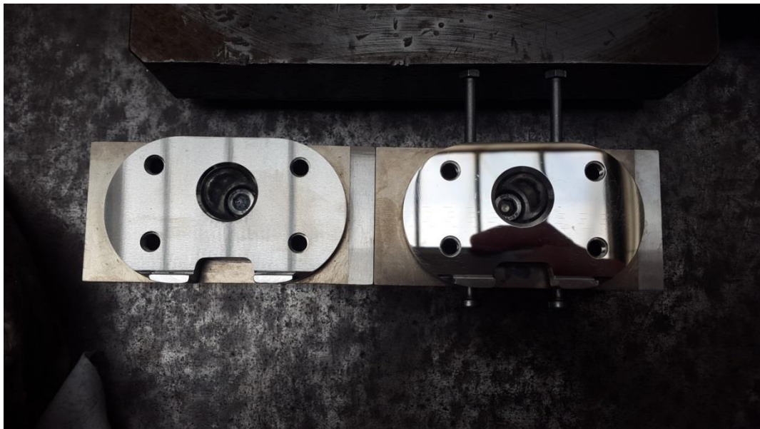
Obrázek 25: Vyleštěné Tibiální plato po 1. pokusu (vpravo) v porovnání s broušeným (vlevo)
