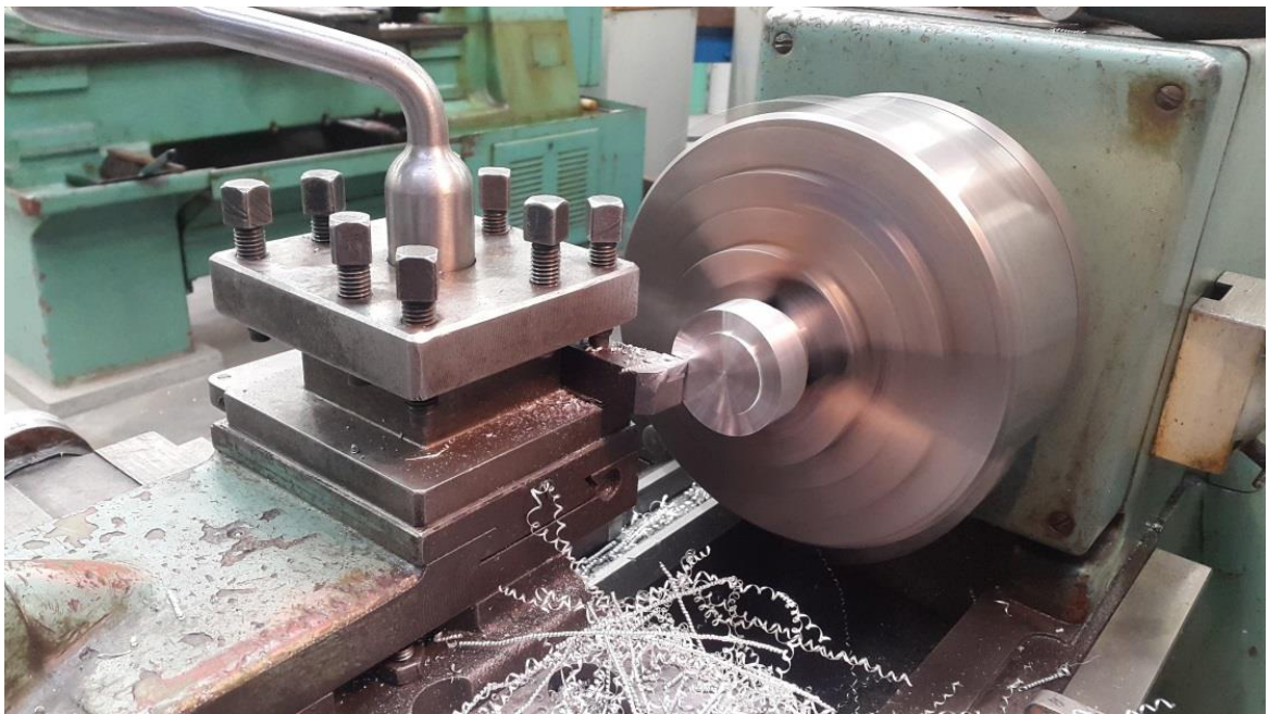
Obrázek 10: Výroba leštící hlavy s lepeným plátnem
