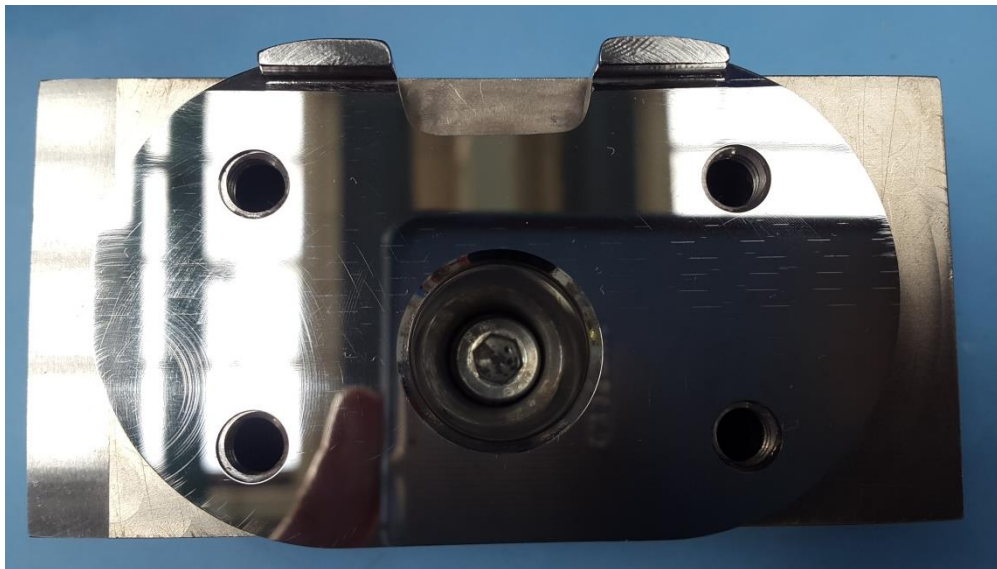
Obrázek 26: Vyleštěná Tibiální plato – pokus 2
