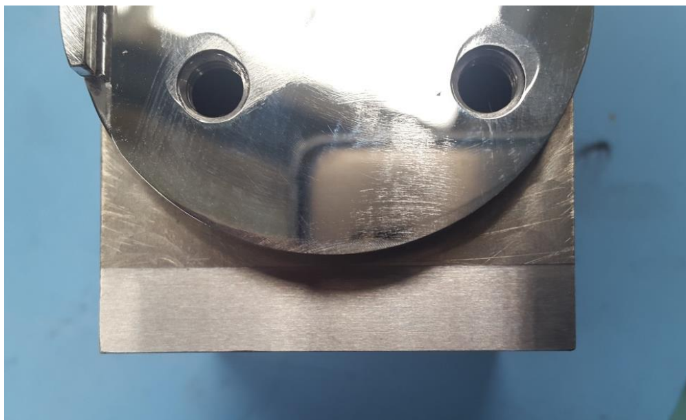
Obrázek 30: Broušená plocha přípravku
