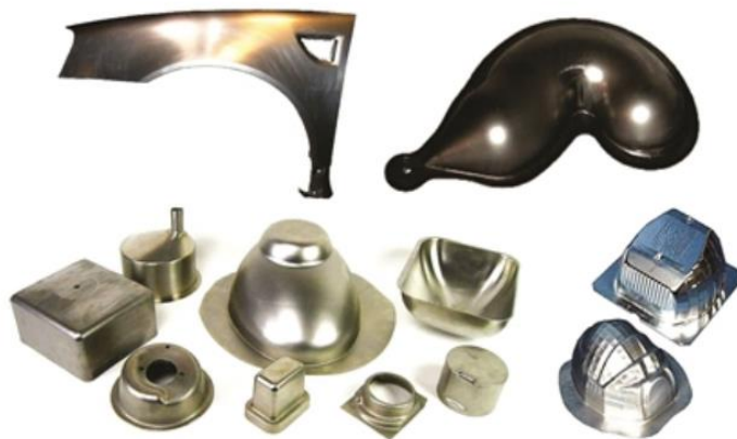
Obr. 7: Příklady tvarových skupin dílců hydroformování plechů [12]
