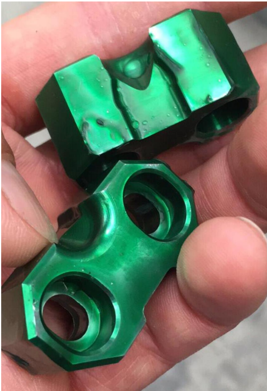
Obr. 103: Finální součásti před tepelným zpracováním
