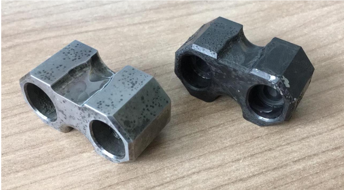
Obr. 104: Součásti s kavítami verze 6 po tepelném zpracování
