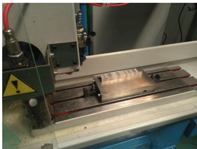
Obr. 21: Broušení zkušebních vzorků na jedno upnutí na magnetu
