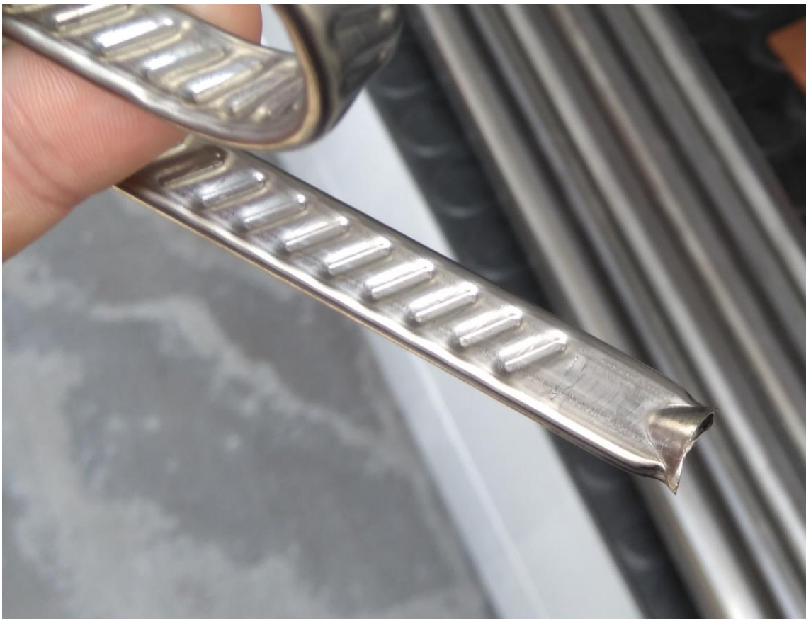
Obr. 15: Trubička zhotovena hydroformingem s vtokovou vložkou ve společnosti Trumpf
