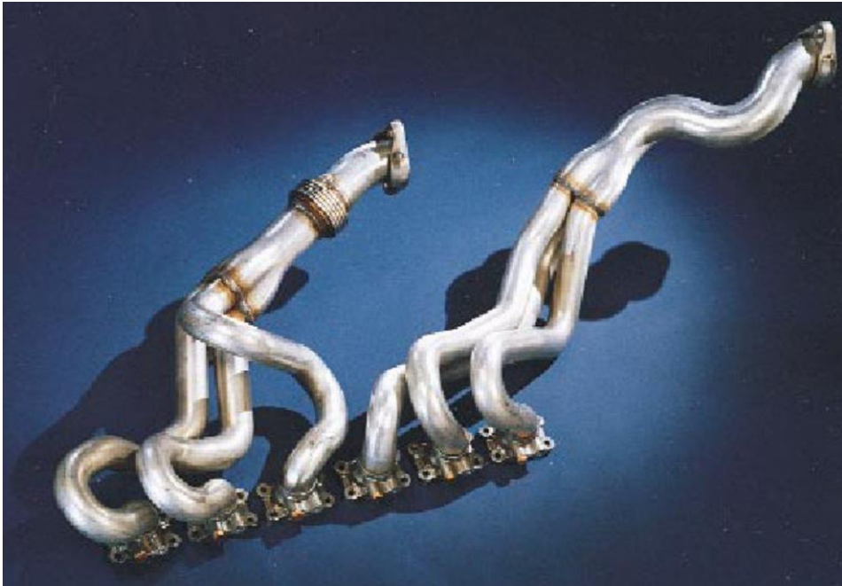
Obr. 2: Tvarované trubky do automobilu pomocí hydroformingu [13]
