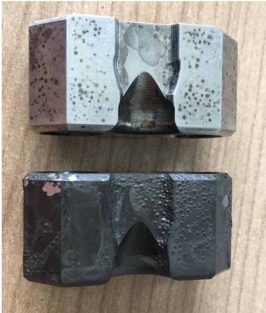
Obr. 105: Součásti s kavítami verze 6 po tepelném zpracování
