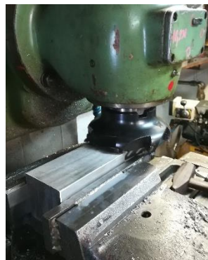
Obr. 4-6 – Frézování na přesné rozměry
