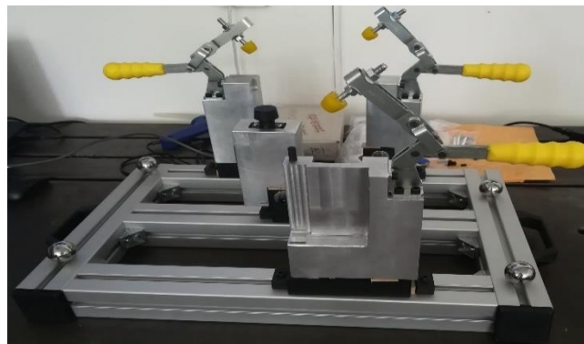
Obr. 4- 19 – Přidání dorazových prvků s upínkami
