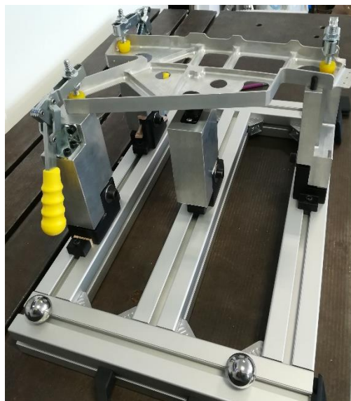
Obr. 4- 22 – Složený přípravek – upnutí součásti
