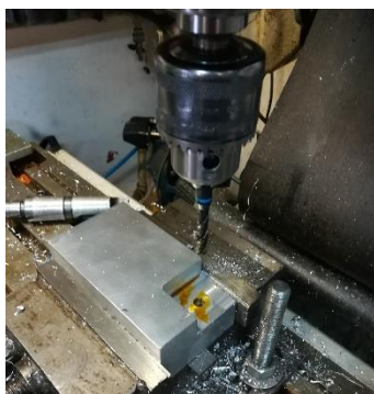
Obr. 4- 12 – Řezání závitu M10
