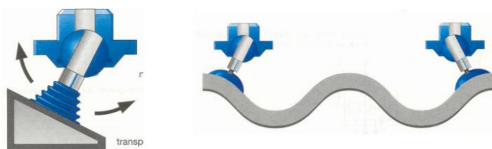
Obr. 28: Schematické znázornění uchopení objektu s nevodorovným povrchem [22]
