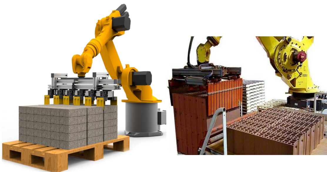
Obr. 29: Robotický manipulátor se speciálním koncovým efektozem od firmy Titan-machinery a řešení pro rozměrově větší výrobky od Tecauma [24] [25]
