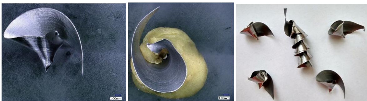
Obr. 117.: Tříška vzniklá při f = 0,1 a v_c = 70 (díra 29).
