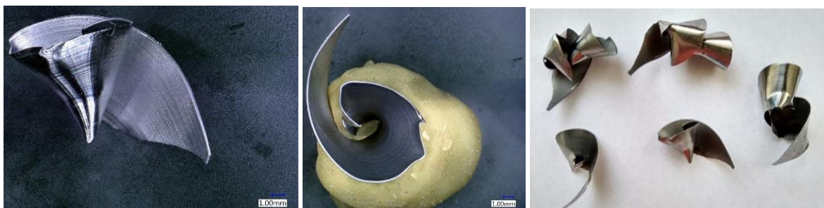
Obr. 120.: Tříška vzniklá při f = 0,15 a v_c = 50 (díra 32).
