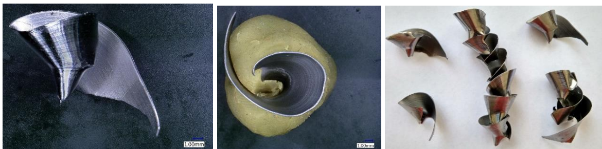
Obr. 123.: Tříska vzniklá při f = 0,2 a v_c = 30 (díra 35).
