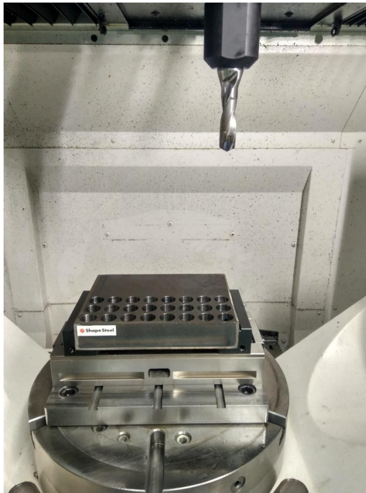
Obr. 52.: Výsledný obrobek po odvrtání sady 24 děr za sucha.
