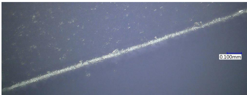
Obr. 66.: Korunka Iscar použitá při vrtání s chladicí kapalinou – Detail břitu.
