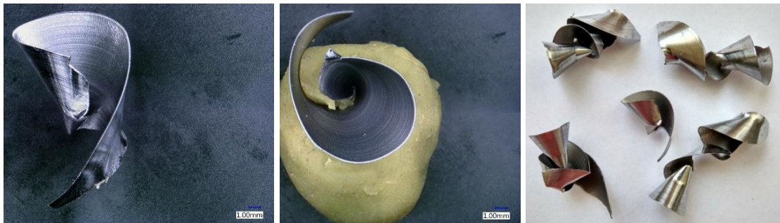
Obr. 121.: Tříska vzniklá při f = 0,15 a v_c = 60 (díra 33).
