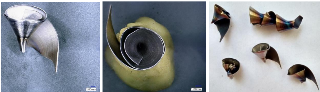
Obr. 96.: Tříška vzniklá při f = 0,15 a v_c = 60 (díra 9).
