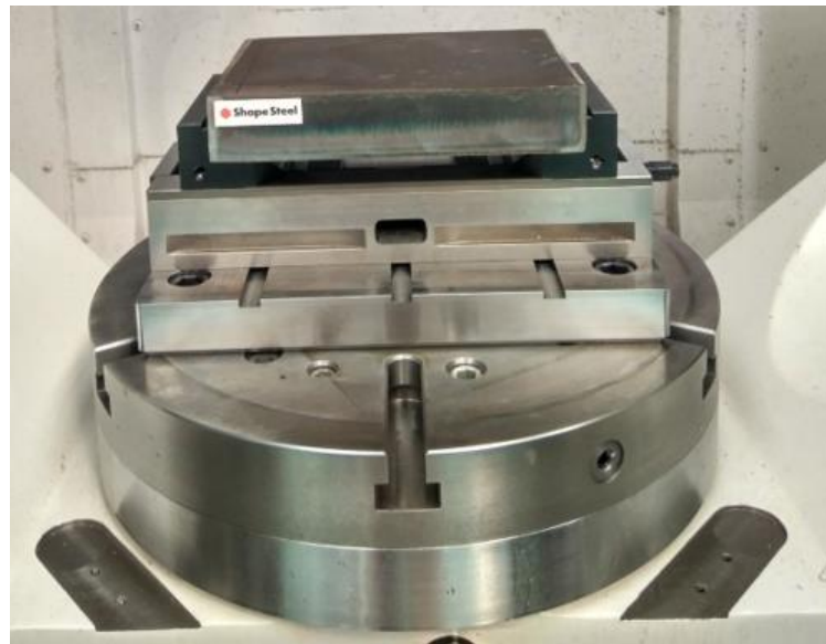
Obr. 48.: Upnutý polotovar S 960 QL s rozměry 40 x 214 x 162 v pracovním prostoru stroje.
