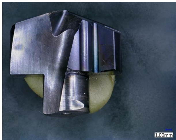
Obr. 55.: Korunka Iscar použitá při vrtání za sucha.
