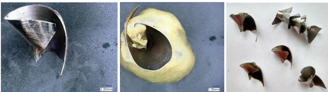
Obr. 104.: Tříška vzniklá při f = 0,25 a v_c = 30 (díra 16).
