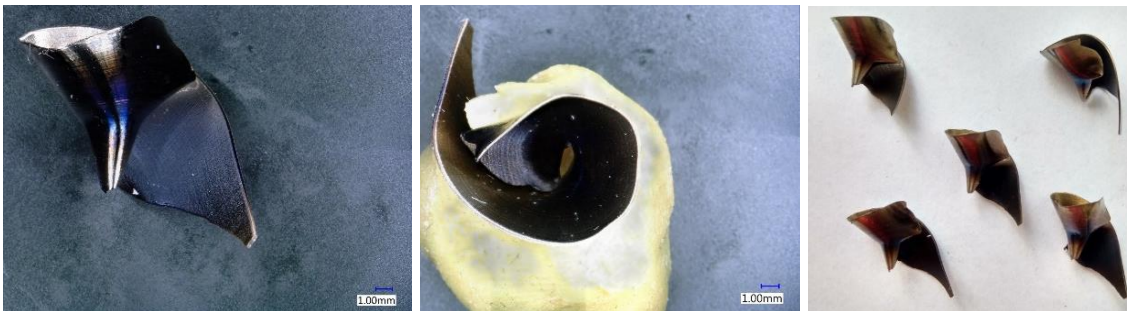
Obr. 99.: Tříška vzniklá při f = 0,2 a v_c = 40 (díra 12).
