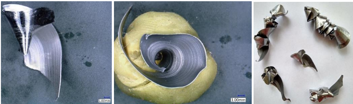
Obr. 113.: Tříška vzniklá při f = 0,1 a v_c = 30 (díra 25).
