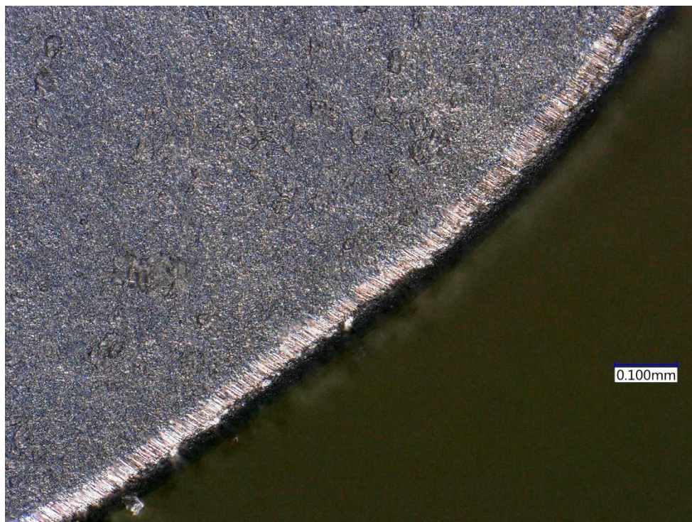
Obr. 67.: Korunka Iscar použitá při vrtání s chladicí kapalinou – Abrasivní opotřebení na hřbetu.
