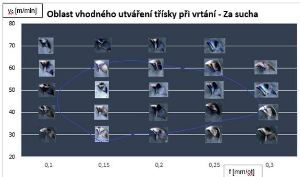
Obr. 137.: Oblast vhodného utváření třísky při vrtání – Za sucha.
