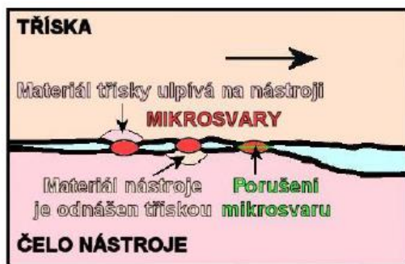
Obr. 24.: Adhezní opotřebení. [21]
