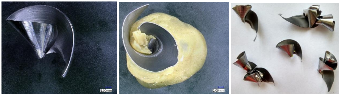
Obr. 118.: Tříška vzniklá při f = 0,15 a v_c = 30 (díra 30).
