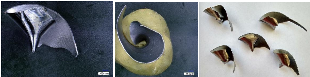
Obr. 131.: Tříška vzniklá při f = 0,25 a v_c = 60 (díra 43).
