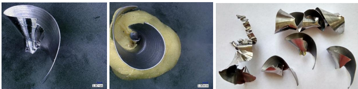
Obr. 119.: Tříška vzniklá při f = 0,15 a v_c = 40 (díra 31).
