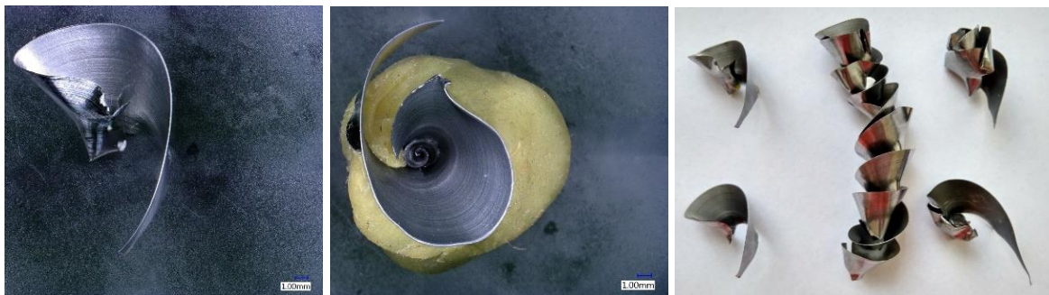
Obr. 116.: Tříška vzniklá při f = 0,1 a v_c = 60 (díra 28).
