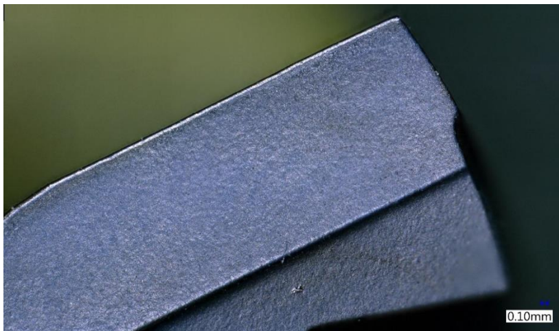
Obr. 58.: Korunka Iscar použitá při vrtání za sucha – Pohled na hřbet.
