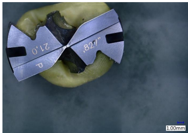
Obr. 56.: Korunka Iscar použitá při suchém vrtání (karbid typu P, \varnothing 21 mm) – Pohled shora.
