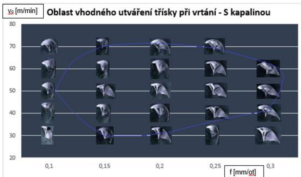
Obr. 138.: Oblast vhodného utváření třísky při vrtání – S kapalinou.
