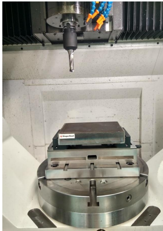
Obr. 51.: Upnutý polotovár před zahájením vrtání sady 24 děr za sucha.
