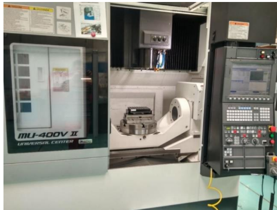
Obr. 42.: Stroj MU - 400V II s upnutým polotovarem.
