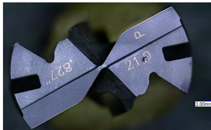
Obr. 64.: Korunka Iscar použitá při vrtání s chladicí kapalinou – Pohled shora.
