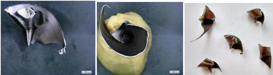
Obr. 98.: Tříška vzniklá při f = 0,2 a v_c = 30 (díra 11).
