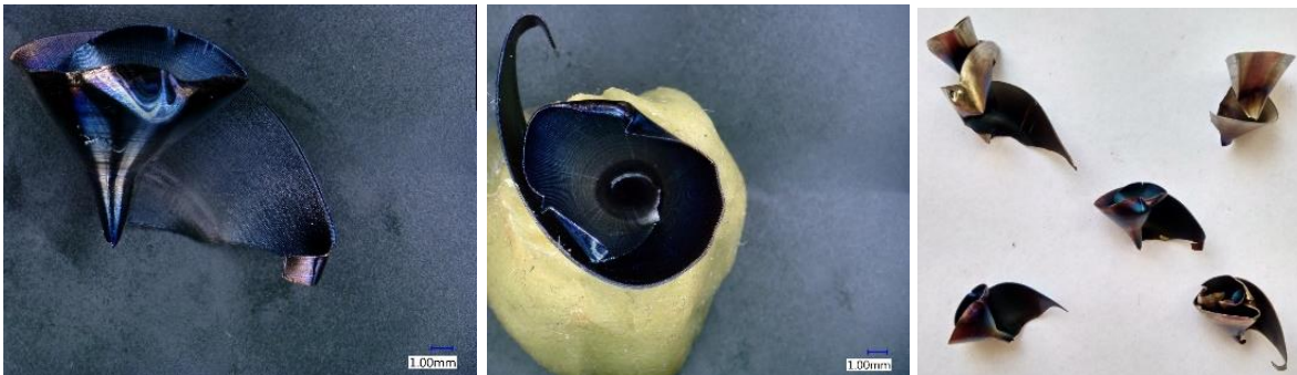
Obr. 97.: Tříška vzniklá při f = 0,15 a v_c = 70 (díra 10).
