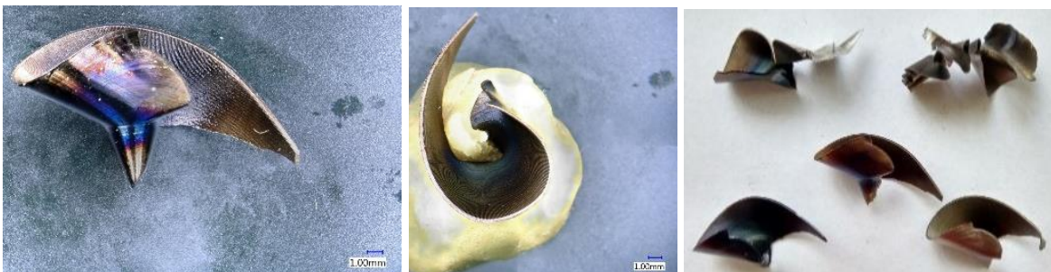
Obr. 112.: Tříška vzniklá při f = 0,3 a v_c = 60 (díra 24).
