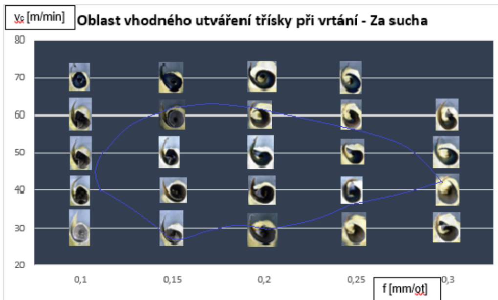
Obr. 139.: Oblast vhodného utváření třísky při vrtání – Za sucha – Pohled shora.
