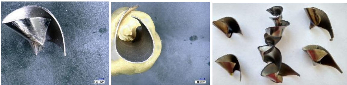
Obr. 110.: Tříška vzniklá při f = 0,3 a v_c = 40 (díra 22).
