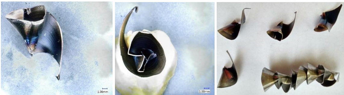
Obr. 95.: Tříška vzniklá při f = 0,15 a v_c = 50 (díra 8).
