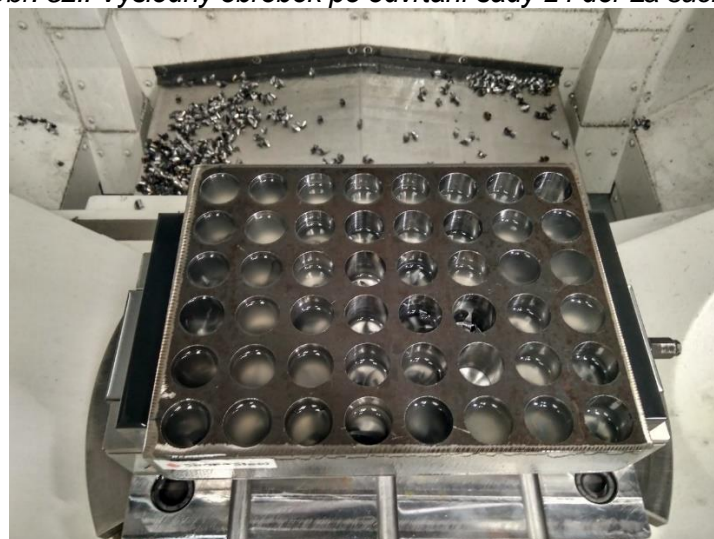
Obr. 53.: Výsledný obrobek po odvrtání všech 48 děr (za sucha i s chladicí kapalinou).
