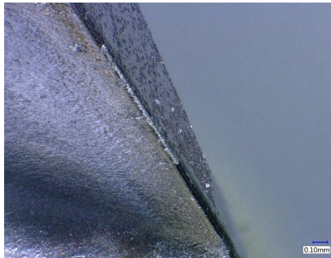
Obr. 60.: Korunka Iscar použitá při vrtání za sucha – Nárůstek na břítu.
