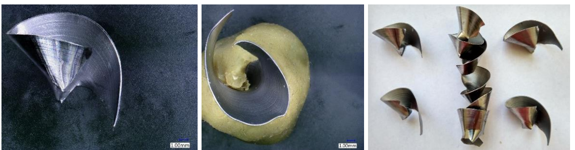
Obr. 126.: Tříška vzniklá při f = 0,2 a v_c = 60 (díra 38).
