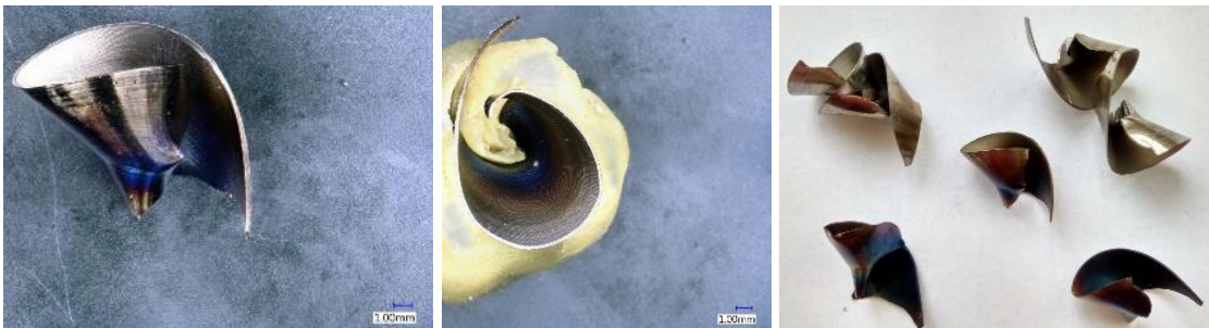
Obr. 107.: Tříška vzniklá při f = 0,25 a v_c = 60 (díra 19).
