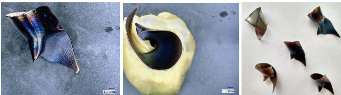
Obr. 106.: Tříška vzniklá při f = 0,25 a v_c = 50 (díra 18).
