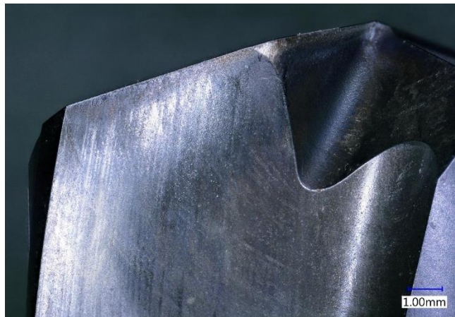
Obr. 57.: Korunka Iscar použitá při vrtání za sucha – Pohled na břít.
