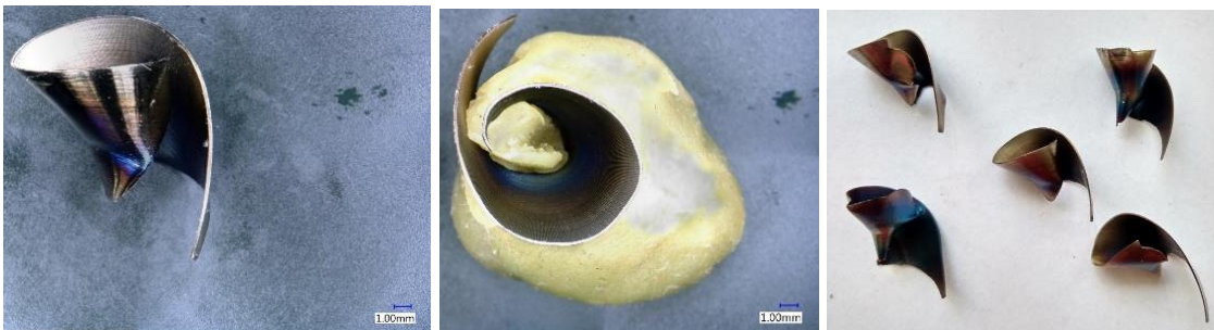
Obr. 101.: Tříška vzniklá při f = 0,2 a v_c = 60 (díra 14).
