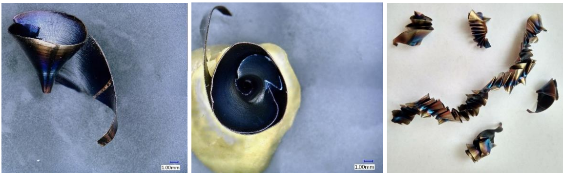
Obr. 92.: Tříška vzniklá při f = 0,1 a v_c = 70 (díra 5).
