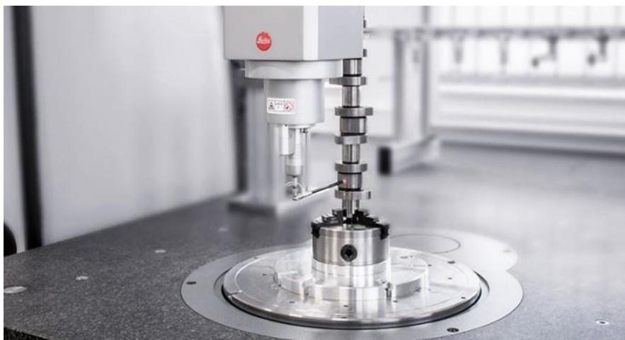
Obrázek 11 – Měření vačkové hřídele s využitím otočného stolu [12]
