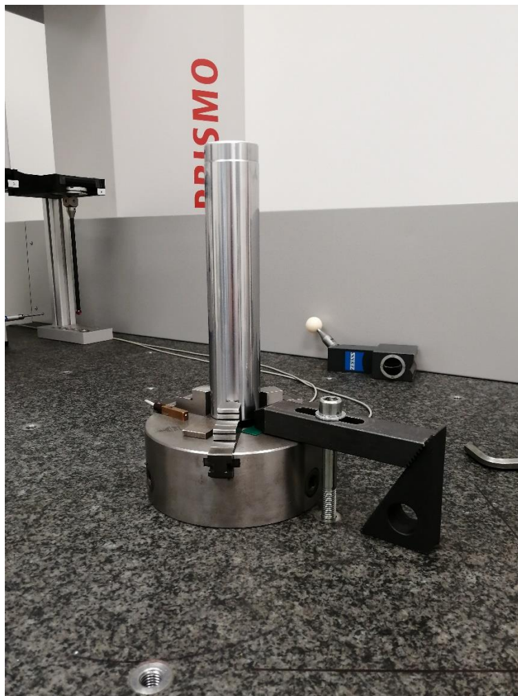
Obrázek 40 - Upnutí sklíčidla k CMM
