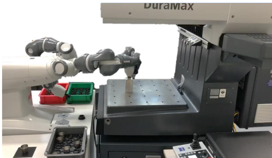
Obr. 92: Použití instrukce ContactL pro dotlačení předmětu kontroly do přípravku
