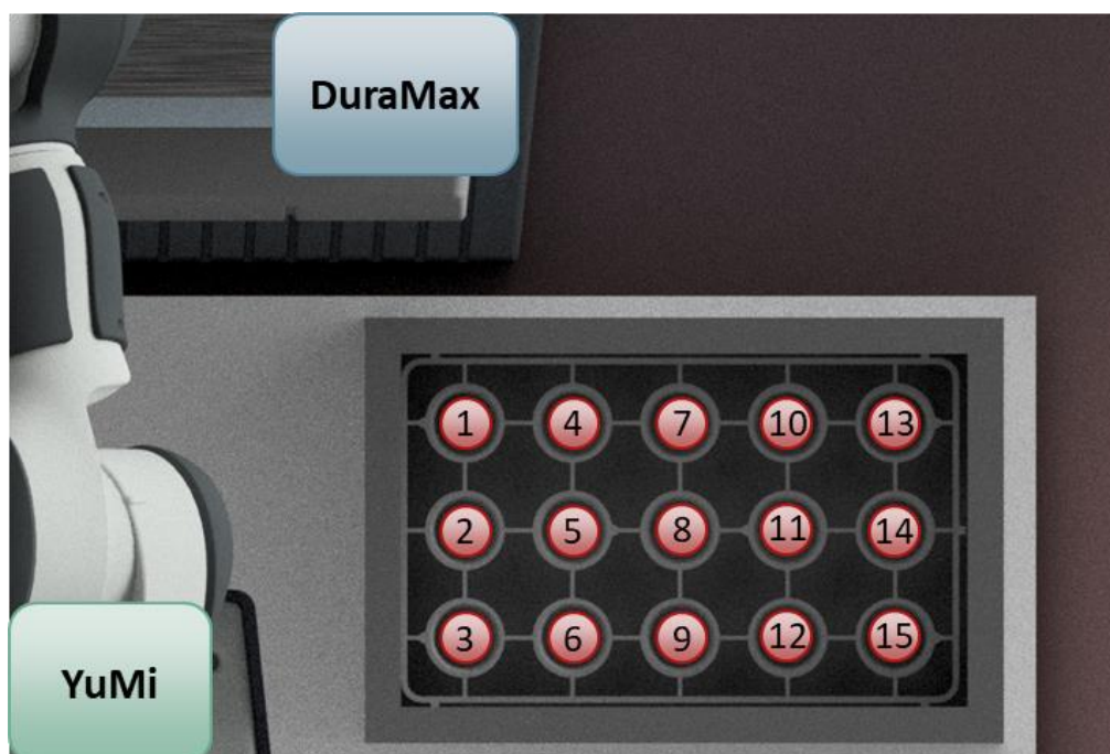
Obr. 76: Číslování pozic předmětů kontroly v přepravce
