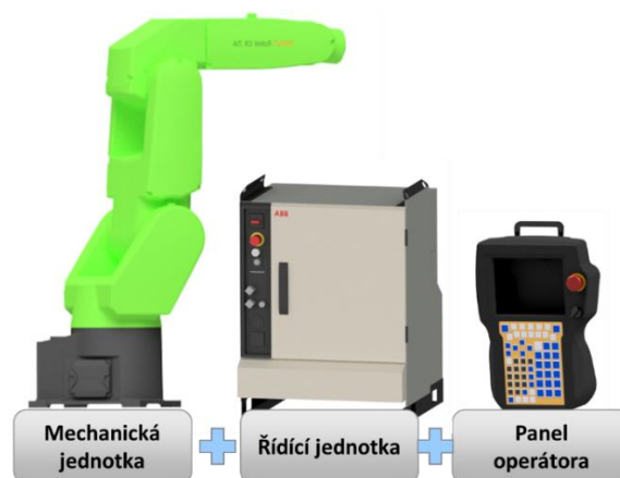
Obr. 3: Hlavní části kompletního průmyslového robota
