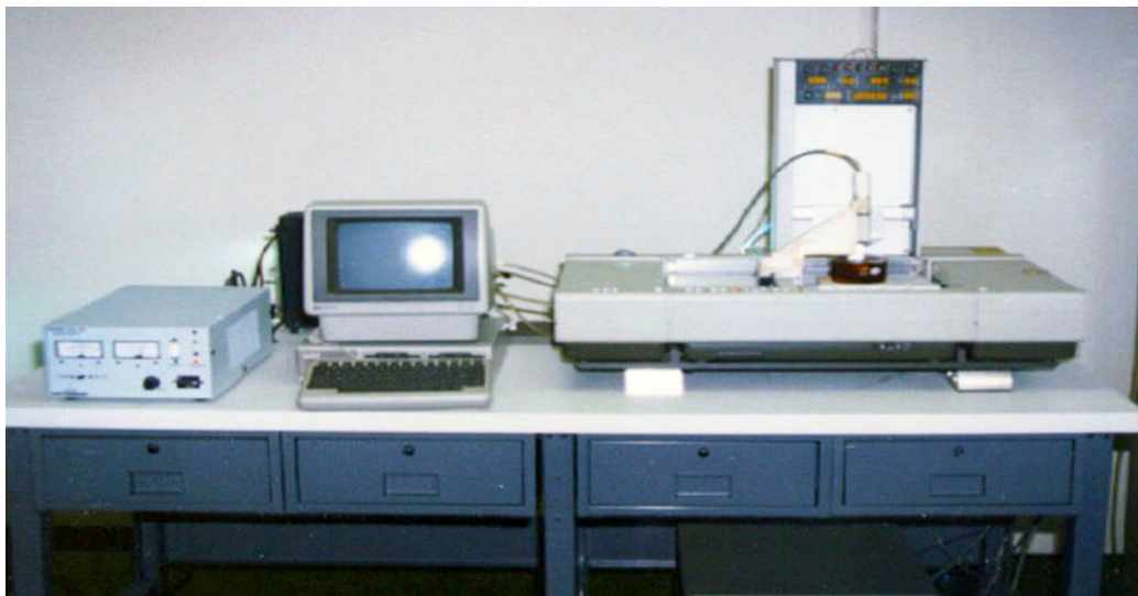
Obr.3: Komerčně prodávaná tiskárna SLA-1 od společnosti 3D Systems (1988)[2]
