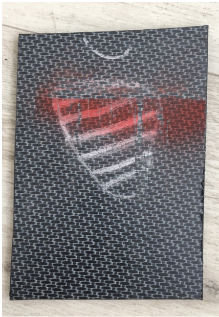
Obrázek 50: Vyřiznutá část z dílu číslo 3 s oblastí porozity
