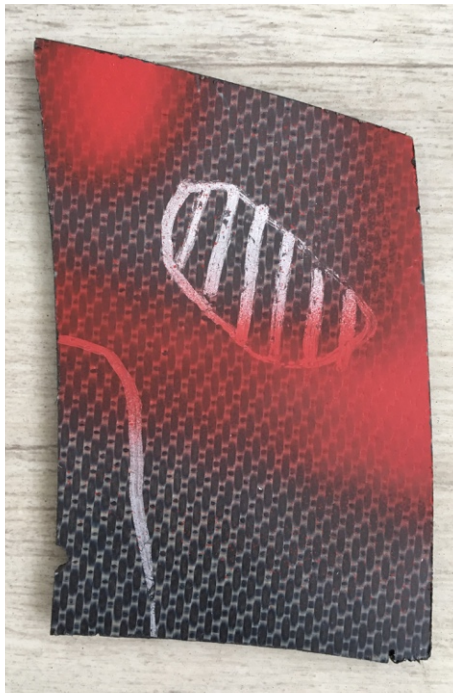
Obrázek 45: Vyřiznutý díl č. 2 s oblastí porozity
