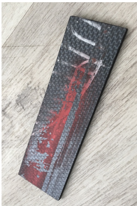
Obrázek 40: Vyřeznutý díl č. 1 s oblastí porozity Obrázek 41: Díl č. 1 s detekovanou porozitou pomocí CT
