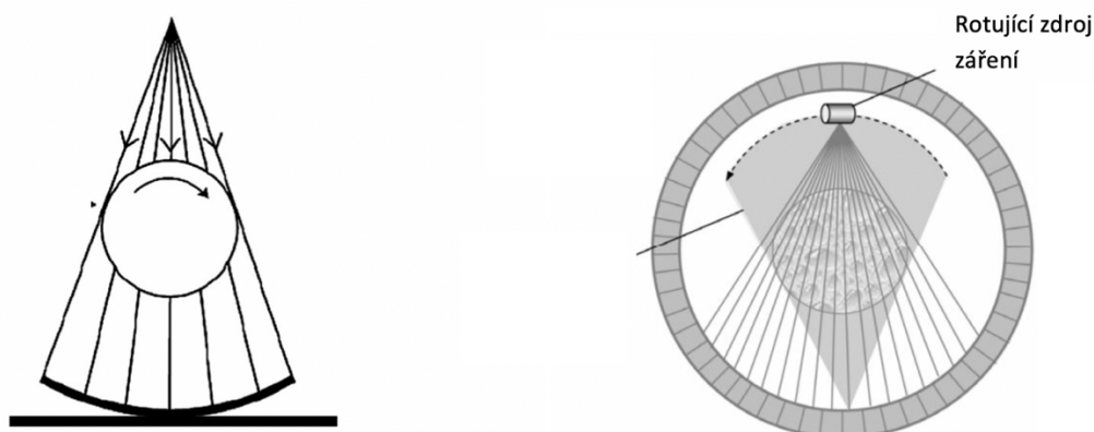
Obrázek 11: Porovnání statického a helikálního CT [2], [15]
