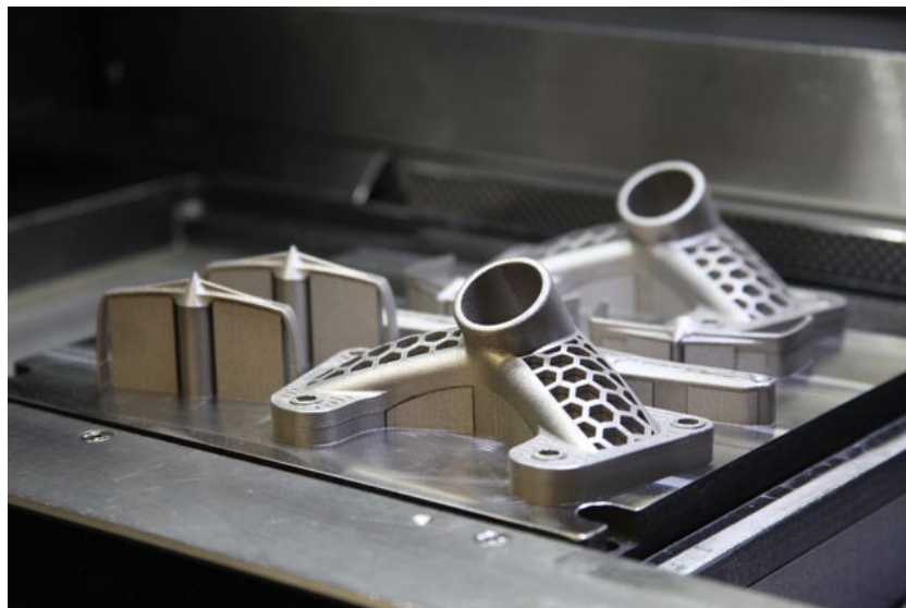
Obrázek 3.9 - Výrobek vytvořený technologií PBF [16]
