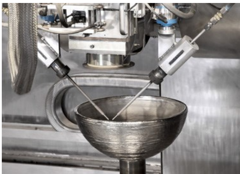
Obrázek 3.18 - Výroba technologií EBAM [23]
