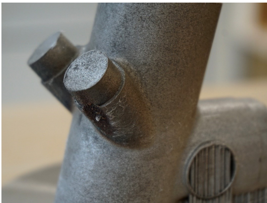
Obrázek 4.32 - Detail poškození sedlové vzpěry
