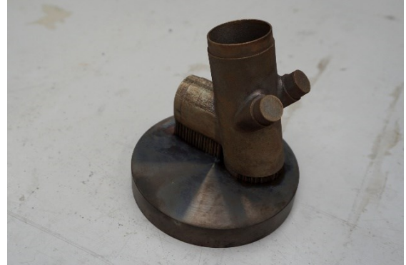
Obrázek 4.23 - Součást po TZ (2)
