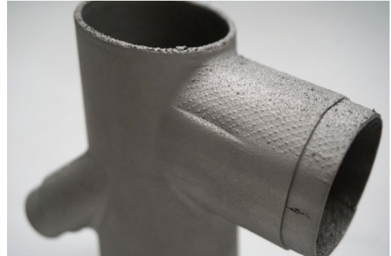
Obrázek 4.34 - Detail vady spojky (2)
