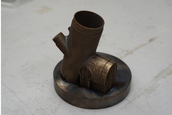
Obrázek 4.22 - Součást po TZ (1)
