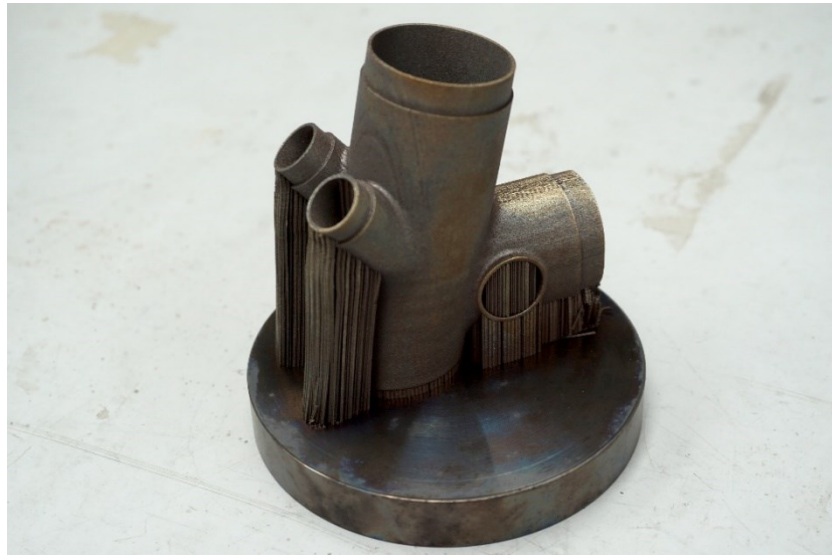
Obrázek 4.40 - Součást po tepelném zpracování
