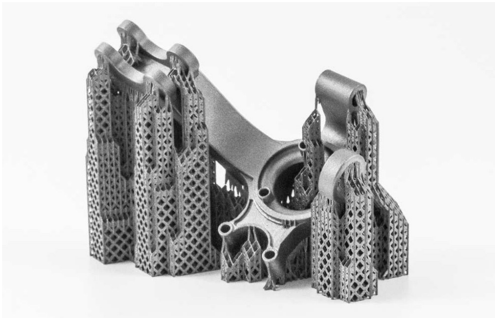
Obrázek 3.6 - Příklad složité podpůrné konstrukce [11]
