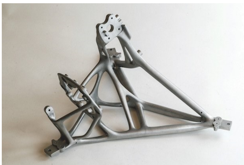
Obrázek 3.26 - Topologicky optimalizovaný držák pro vesmírný výzkum [41]
