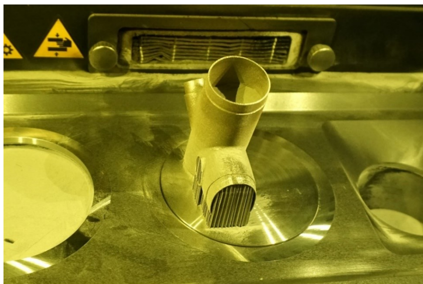
Obrázek 4.21 - Součást po dokončení tisku
